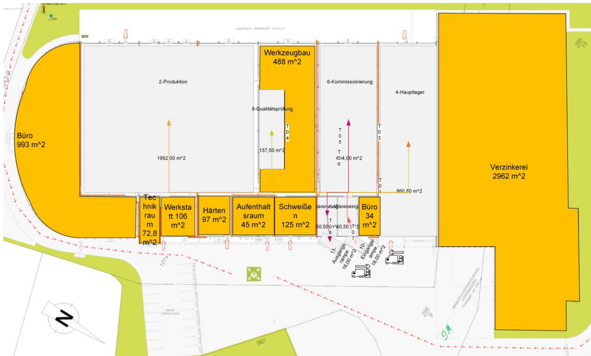
Abbildung 3-25: Grundriss Unternehmen 2 mit Transport-Pfeilen
