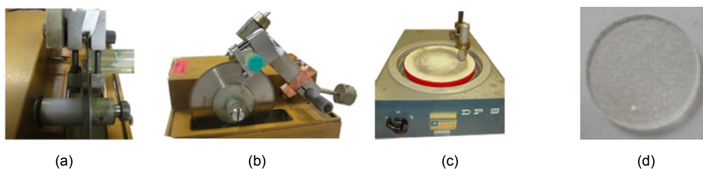
Abb. 5-14: Probenfertigung - Schneiden und Polieren der Plättchenproben
