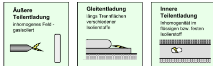
Abb. 2-20: Typische Anordnungen von Teilentladungen [87]
