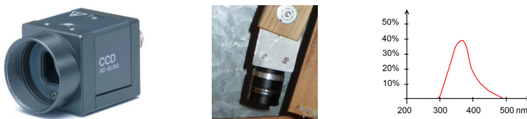
Abb. 5-28: CCD Kamera und spektrale Empfindlichkeit (Herstellerangabe)
