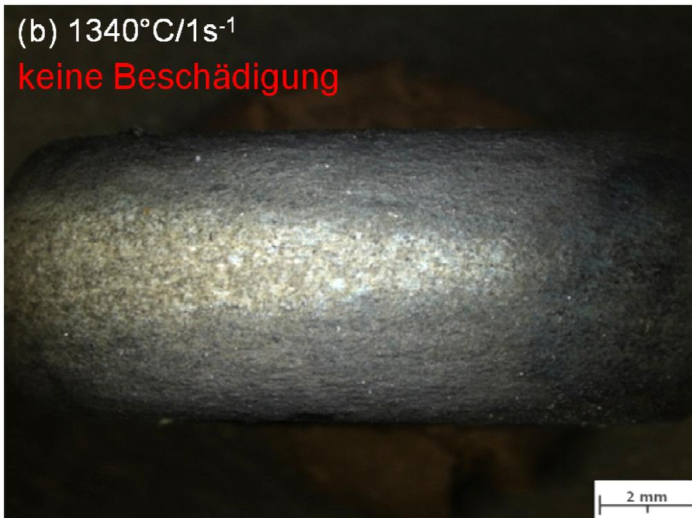
Abbildung 59: Stereobilder von verformten Proben mit und ohne äußere Schädigung (a) 1180°C/1s<sup>-1</sup> und (b) 1340°C/1s<sup>-1</sup>
