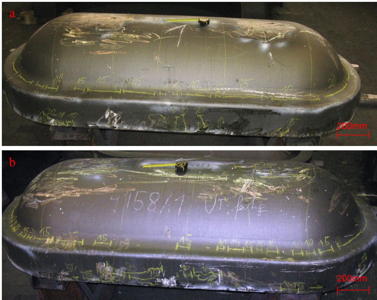
Abbildung 52: Ergebnisse der Ultraschallprüfung der Gussform 1 an den Außenseiten a und b
