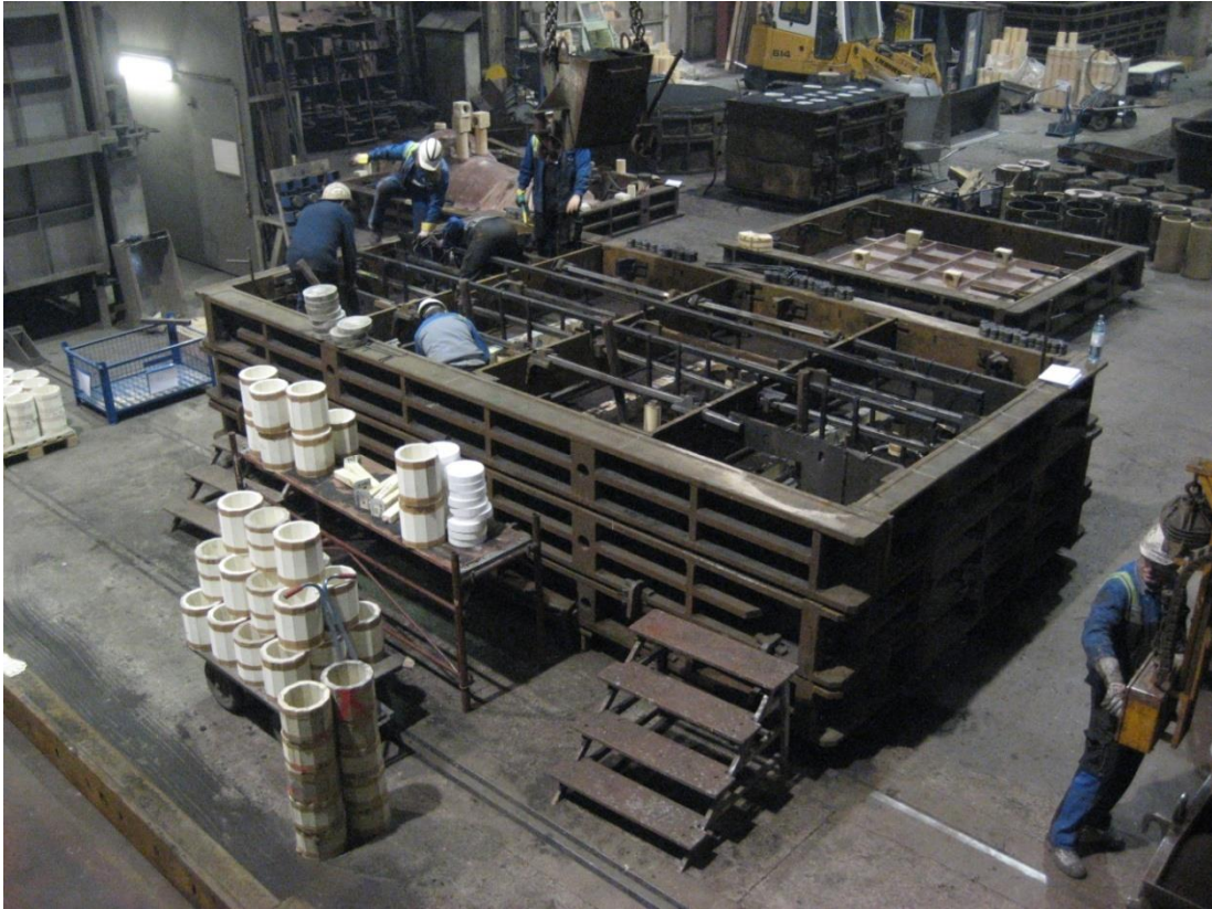
Abbildung 48: Formkasten während dem Plazieren der Verhänge im Oberteil
