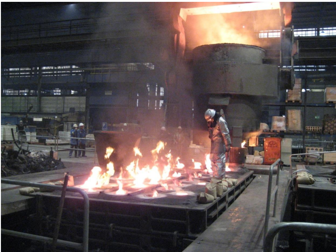
Abbildung 49: Sandform unmittelbar nach dem Abguß
