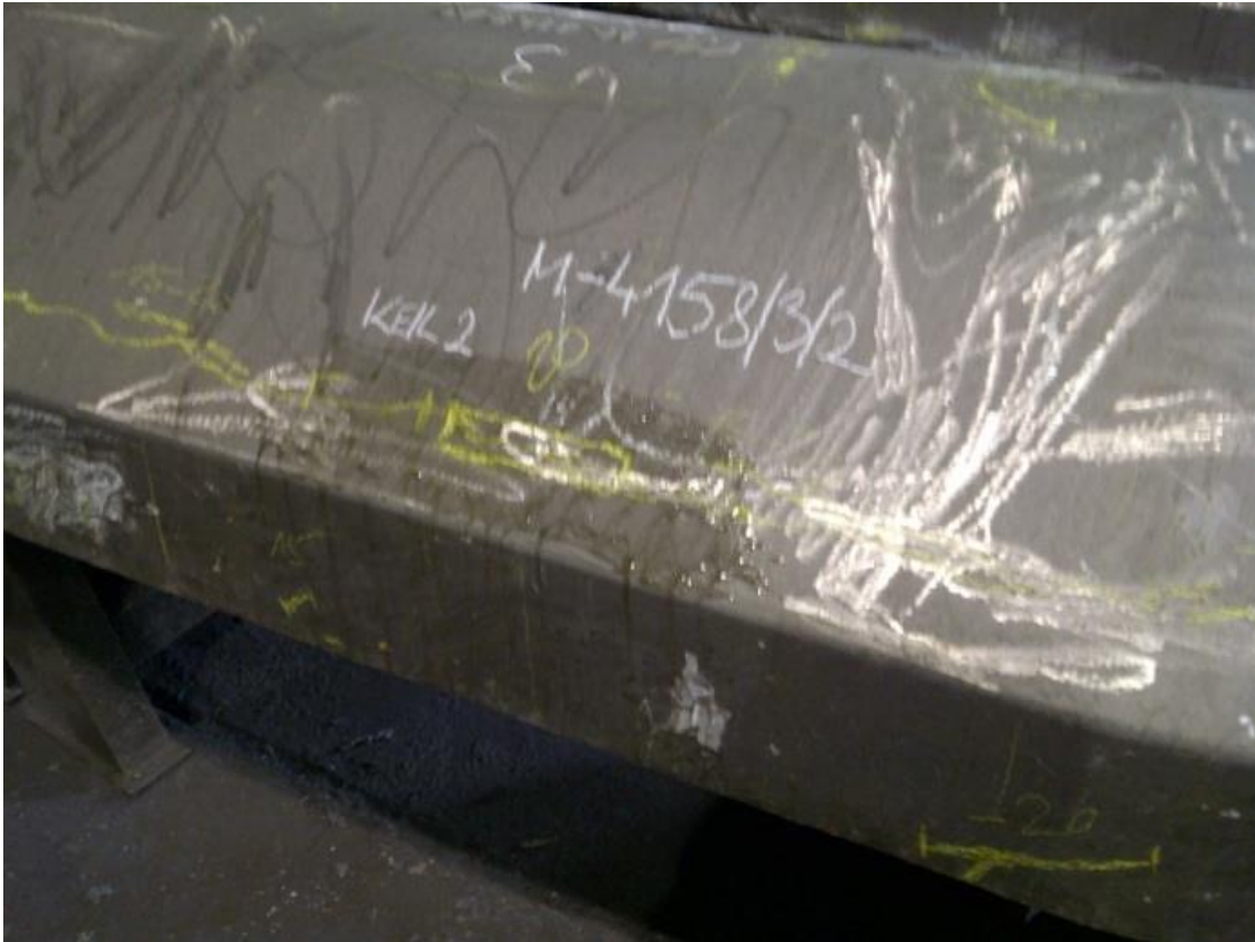
Abbildung 78: Entnahmestellen für die metallographischen Untersuchungen (LiMi) an der Gussform 3 - M-4158/3/2
