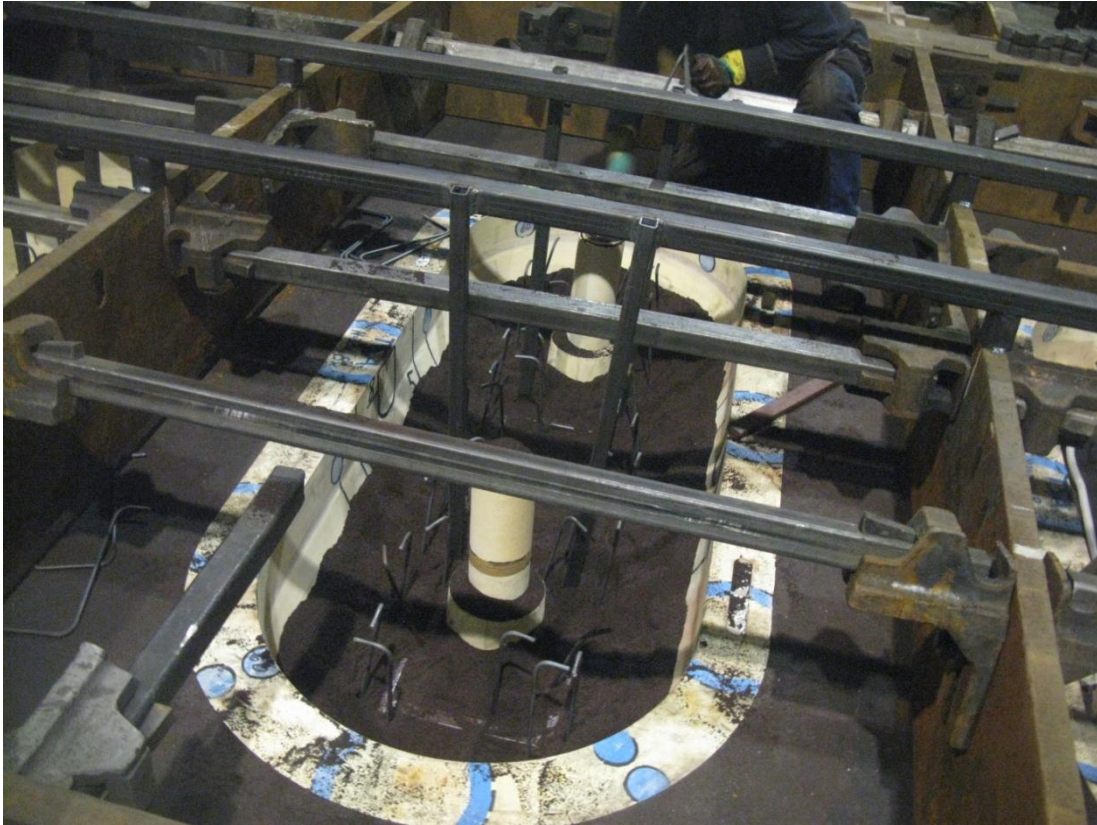
Abbildung 47: Armierung der Sandform
