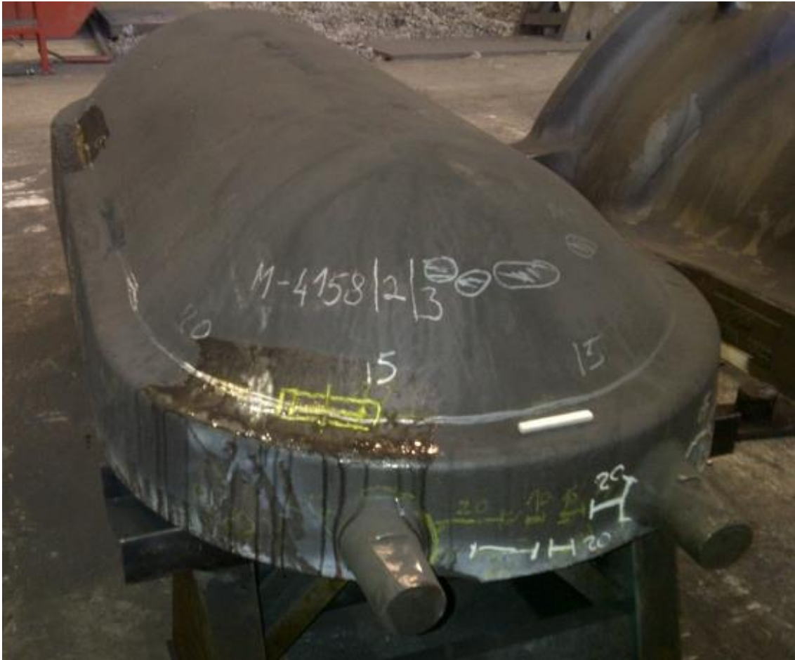
Abbildung 76: Entnahmestelle für die metallographischen Untersuchungen (LiMi) an der Gussform 2 M-4158/2/3
