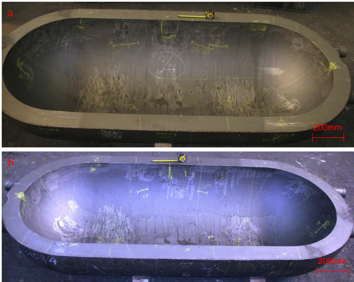
Abbildung 70: Ergebnisse der Ultraschallprüfung der Gussform 4 an der Innenseite a und b im geraden Bereich
