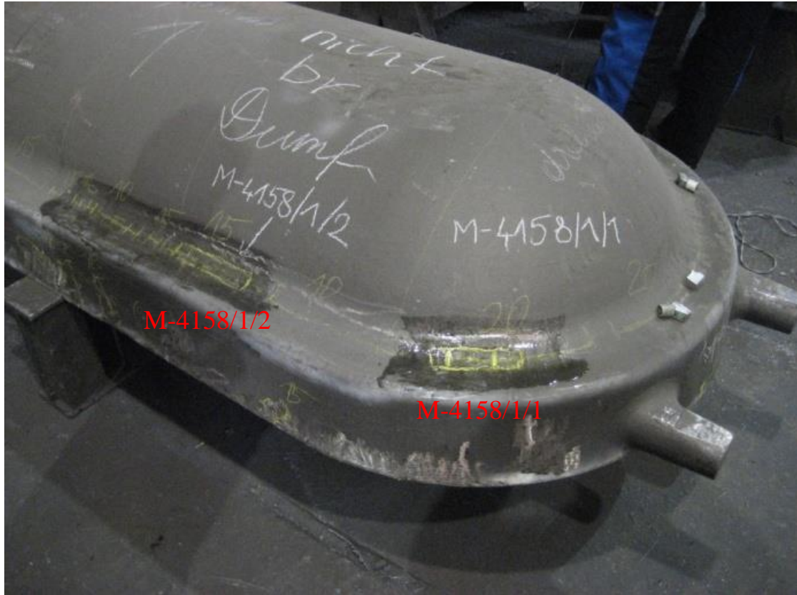
Abbildung 73: Entnahmestellen für die metallographischen Untersuchungen (LiMi) an der Gussform 1 (M-4158/1/1, M-4158/1/2)
