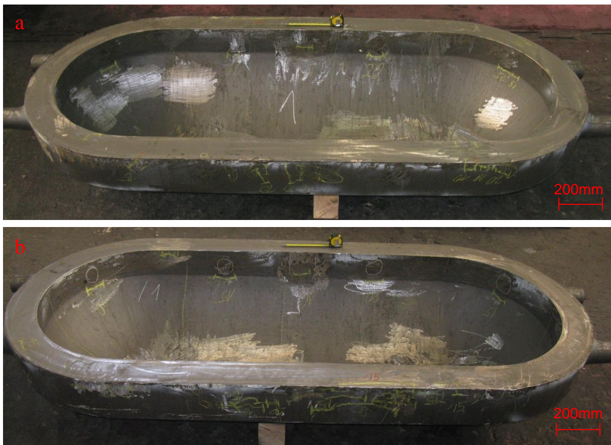
Abbildung 55: Ergebnisse der Ultraschallprüfung der Gussform 1 an der Innenseite a und b im geraden Bereich
