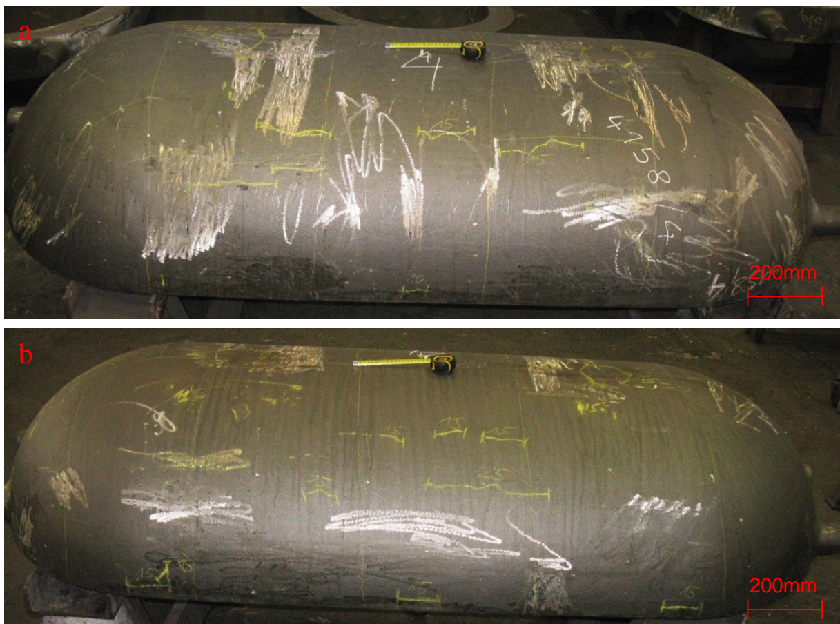
Abbildung 67: Ergebnisse der Ultraschallprüfung Gussform 4 an den Außenseiten a und b der
