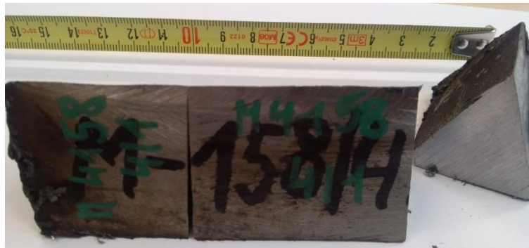
Abbildung 72: Herausgeschnittene Keilprobe Nr. M-4158/4 aus der Gussform 4
