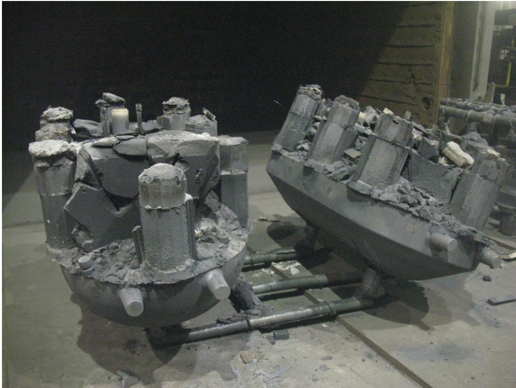
Abbildung 50: Gussform 3 (rechts) und 4 (links) nach dem Ausschlagen
