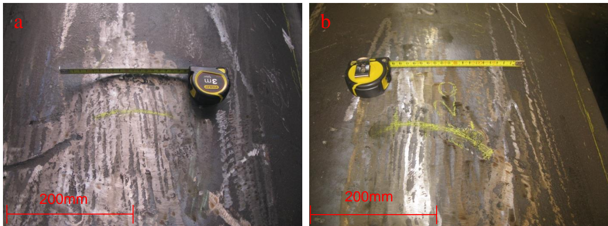
Abbildung 59: Ergebnisse der Ultraschallprüfung der Gussform 2 im Bereich des Anschnitts an der Außenseite a und b
