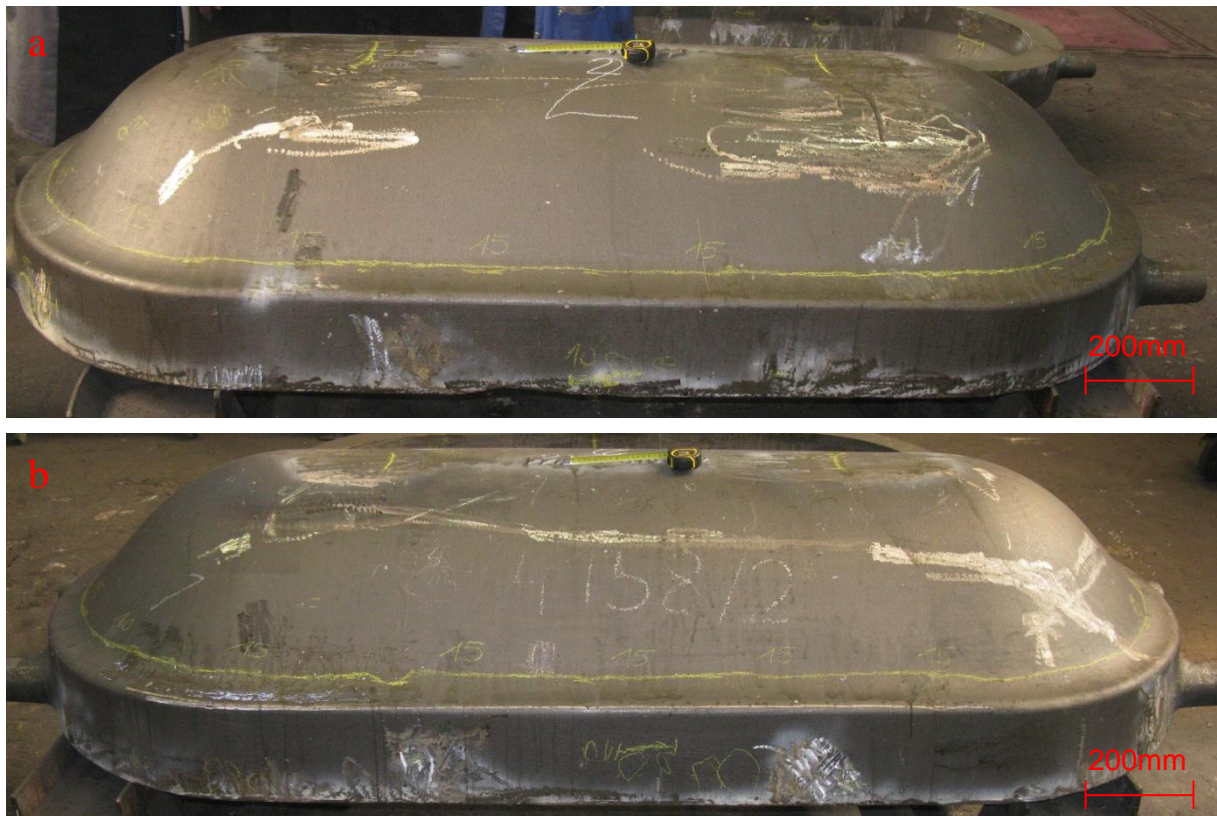
Abbildung 57: Ergebnisse der Ultraschallprüfung der Gussform 2 an den Außenseiten a und b
