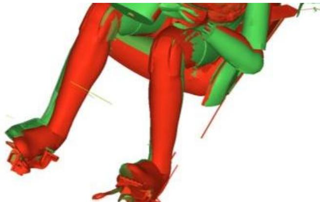
Abbildung 79 Vergleich von Beinpositionen mit 6DOF (grün) und 3DOF lokales Nicken + Vorverdrehung (rot) bei einem Fahrzeug der Mittelklasse im Lastfall EuroNCAP (t=112,5 ms)
