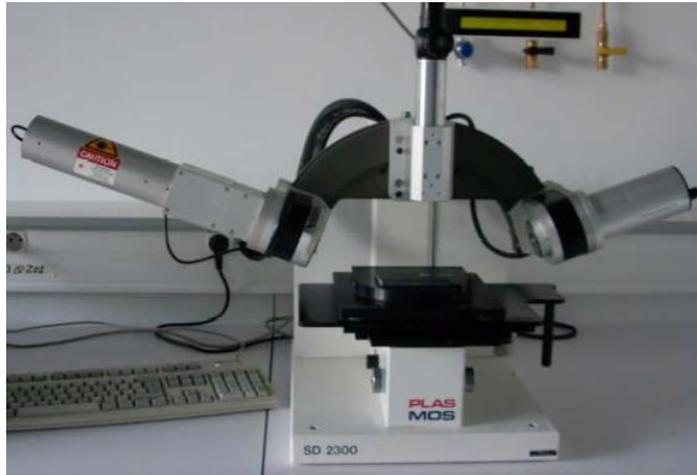
Abbildung 2.38.: Foto eines Plasmos SD 2300 Ellipsometer zur Dicken- und Brechungsindexmessung von dünnen Schichten [36]
