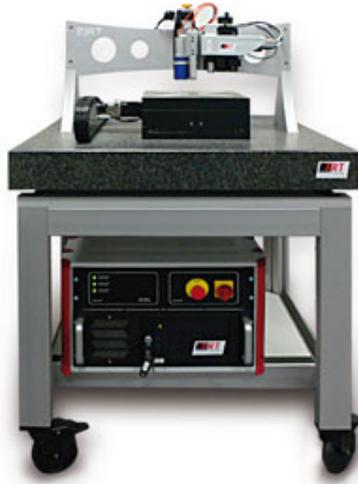
Abbildung 2.42.: Das Oberflächenprofilometer FRT MicroProf 200 ist ein Messgerät zur präzisen Messung der Topographie von Oberflächen.
