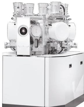
Abbildung 2.37.: Der MiniSprinter von Oerlikon ist eine Sputteranlage mit fünf Prozesskammern. Es gibt zwei RF Kammern, eine DC, und eine DC Multitarget Kammer. Eine weitere Kammer ist für Plasmabehandlungen ausgelegt.
