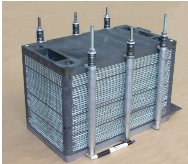
Abbildung 4.4: Foto eines SOFC-Stacks (Kugelschreiber als Größenvergleich), der eine Leistung von 5 kW erbringt [35]
