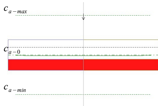
Abbildung 6.37: Verlauf des Auftriebsbeiwertes c_a entlang des Höhenleitwerks
