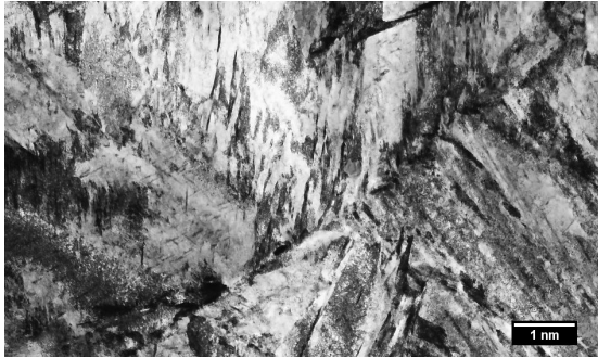
Abbildung 45: TEM, Substruktur der M-400 Probe
