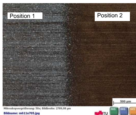
Abbildung 70: Übersicht Längsschliff, Bainitieren an der Gleeble, 40CrMoV4-6
