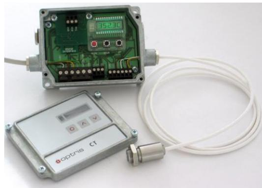
Abbildung 36 – Pyrometer
