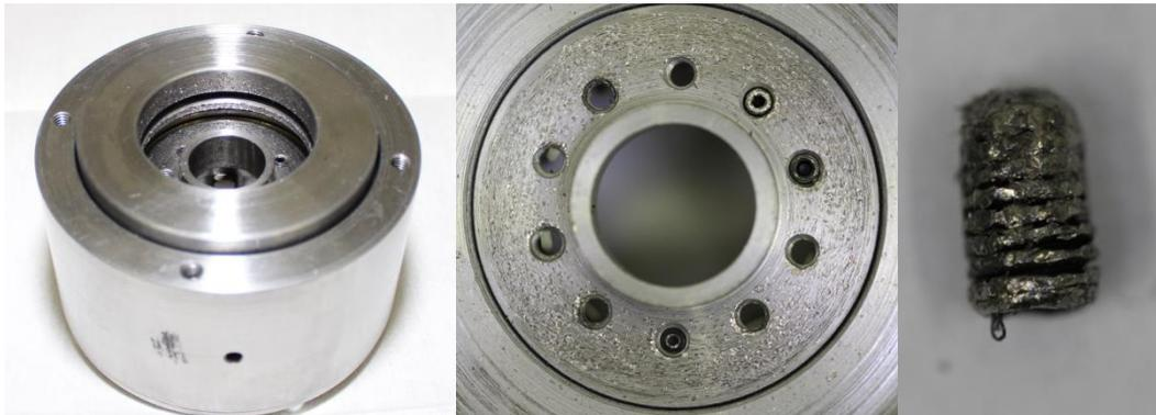
Abbildung 34 - Magnetkupplung Schaden
