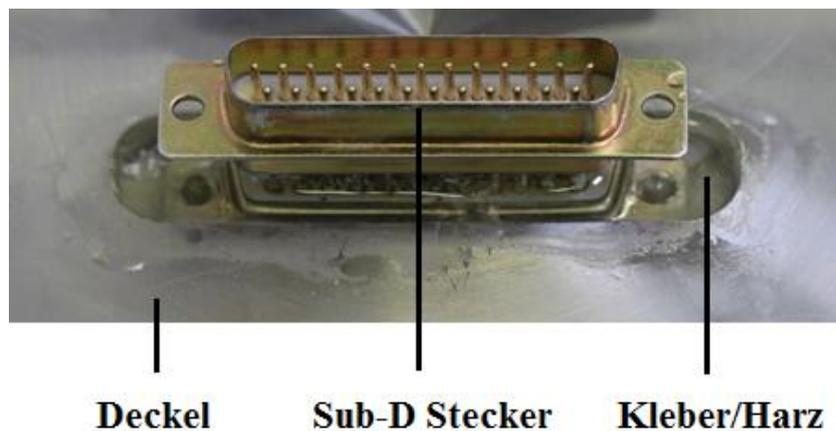
Abbildung 44 - Vakuumdurchführung 25-poliger Sub-D Stecker
