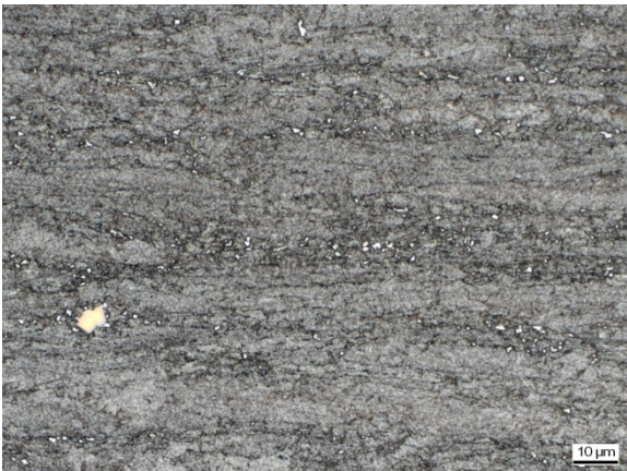
Abbildung C 101: WEZ Simulation (S 700MC, Blechdicke 12mm), T_{\max} = 792,2 \text{ }^{\circ}\text{C} , t_{8/5} = 4,3 \text{ s}
