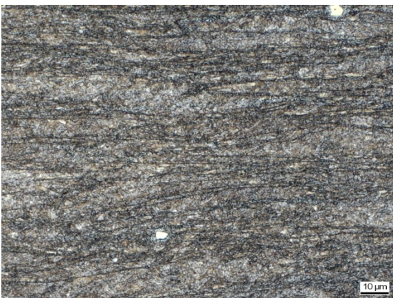
Abbildung C 71: Grundwerkstoff (S 700MC, Blechdicke 12mm)
