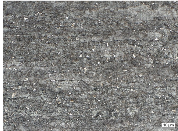
Abbildung C 100: WEZ Simulation (S 700MC, Blechdicke 12mm), T_{\max} = 826,9 \text{ }^{\circ}\text{C} , t_{8/5} = 4,5 \text{ s}
