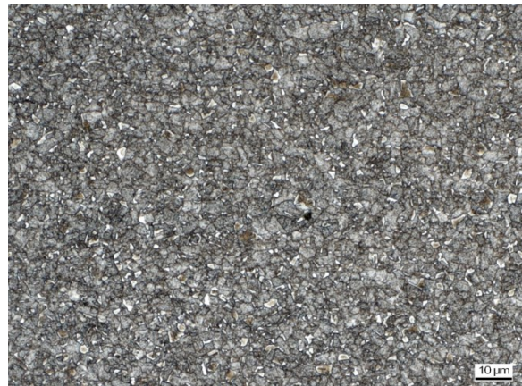
Abbildung C 78: WEZ Simulation (S 700MC, Blechdicke 12mm), T_{\max} = 1091,1 \text{ °C} , t_{8/5} = 5,8 \text{ s}
