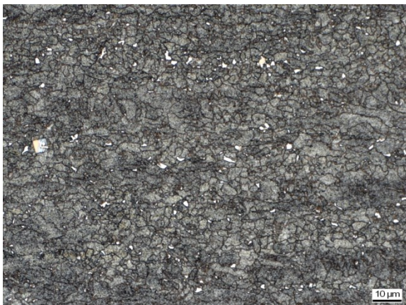
Abbildung C 83: WEZ Simulation (S 700MC, Blechdicke 12mm), T_{\max} = 830,2 \text{ °C} , t_{8/5} = 20,1 \text{ s}
