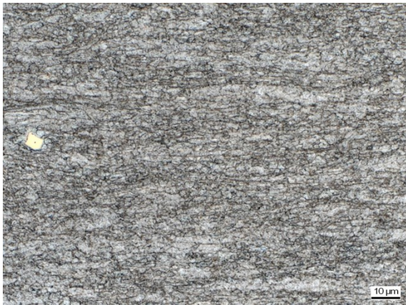
Abbildung C 93: WEZ Simulation (S 700MC, Blechdicke 12mm), T_{\max} = 392,2 \text{ °C} , t_{8/5} = 25 \text{ s}
