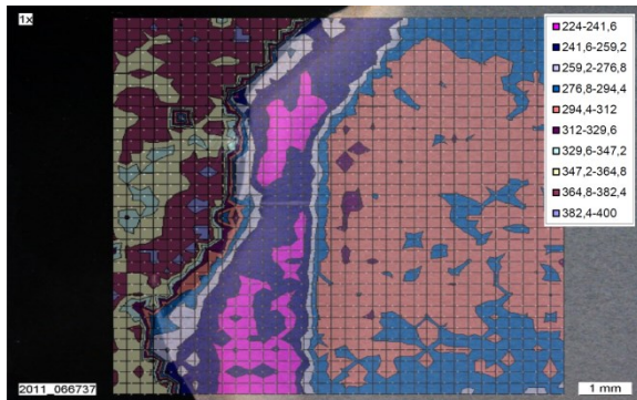
Abbildung 5-48: Härtemapping Schweißnaht V Zusatz C, effektive Streckenenergie 0,99 kJ/mm
