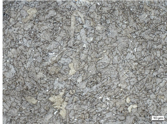
Abbildung C 110: WEZ Simulation (S 700MC, Blechdicke 10 mm), T_{\max}(1)=1260,1^{\circ}\text{C} , t_{8/5}(1)=30,5\text{ s} , T_{\max}(2)=1019,9^{\circ}\text{C} , t_{8/5}(2)=26,3\text{ s}
