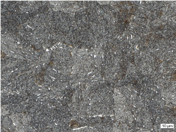
Abbildung C 75: WEZ Simulation (S 700MC, Blechdicke 12mm), T_{\max} = 1243,0 \text{ °C} , t_{8/5} = 27,6 \text{ s}
