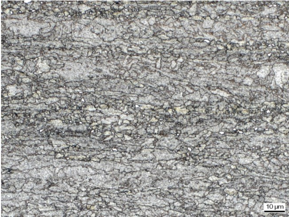
Abbildung C 85: WEZ Simulation (S 700MC, Blechdicke 12mm), T_{\max} = 806,2 \text{ }^\circ\text{C} , t_{8/5} = 21,3 \text{ s}
