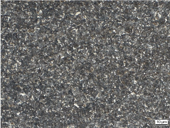
Abbildung C 97: WEZ Simulation (S 700MC, Blechdicke 12mm), T_{\max} = 1031,5 \text{ }^{\circ}\text{C} , t_{8/5} = 3,9 \text{ s}
