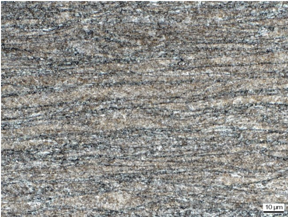
Abbildung C 87: WEZ Simulation (S 700MC, Blechdicke 12mm), T_{\max} = 734,4 \text{ }^\circ\text{C} , t_{8/5} = 20,4 \text{ s}
