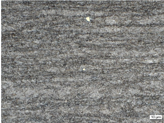
Abbildung C 91: WEZ Simulation (S 700MC, Blechdicke 12mm), T_{\max} = 593,2 \text{ °C} , t_{8/5} = 18,1 \text{ s}
