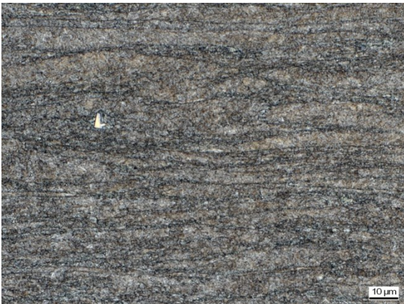
Abbildung C 89: WEZ Simulation (S 700MC, Blechdicke 12mm), T_{\max} = 691,9 \text{ }^\circ\text{C} , t_{8/5} = 19,9 \text{ s}
