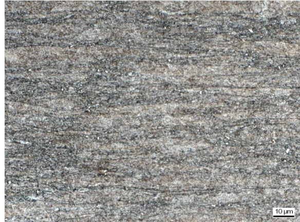
Abbildung C 86: WEZ Simulation (S 700MC, Blechdicke 12mm), T_{\max} = 739,0 \text{ }^\circ\text{C} , t_{8/5} = 7,3 \text{ s}
