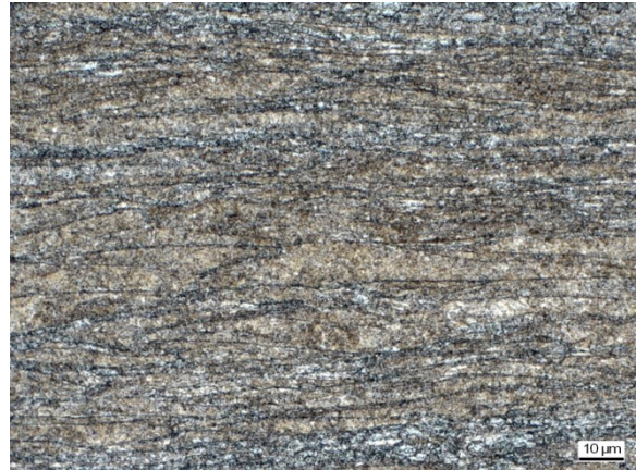
Abbildung C 88: WEZ Simulation (S 700MC, Blechdicke 12mm), T_{\max} = 702,4 \text{ }^\circ\text{C} , t_{8/5} = 7,5 \text{ s}
