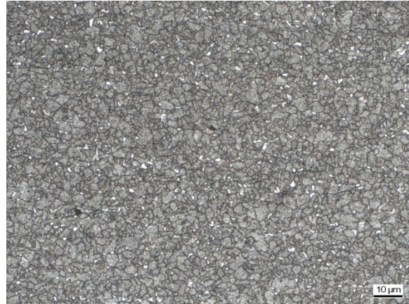
Abbildung C 80: WEZ Simulation (S 700MC, Blechdicke 12mm), T_{\max} = 927,0 \text{ °C} , t_{8/5} = 6,1 \text{ s}
