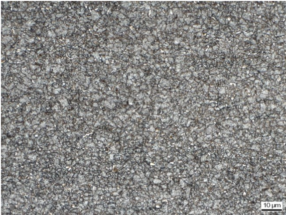
Abbildung C 99: WEZ Simulation (S 700MC, Blechdicke 12mm), T_{\max} = 911,1 \text{ }^{\circ}\text{C} , t_{8/5} = 4,5 \text{ s}
