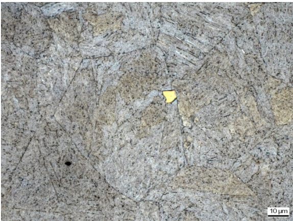
Abbildung C 111: WEZ Simulation (S 700MC, Blechdicke 10 mm), T_{\max}(1)=1320,6^{\circ}\text{C} , t_{8/5}(1)=28,5\text{ s} , T_{\max}(2)=762,9^{\circ}\text{C} , t_{8/5}(2)=25,0\text{ s}
