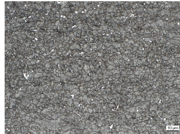
Abbildung C 82: WEZ Simulation (S 700MC, Blechdicke 12mm), T_{\max} = 838,0 \text{ °C} , t_{8/5} = 6,5 \text{ s}
