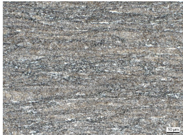
Abbildung C 102: WEZ Simulation (S 700MC, Blechdicke 12mm), T_{\max} = 706,4 \text{ }^{\circ}\text{C} , t_{8/5} = 4,8 \text{ s}
