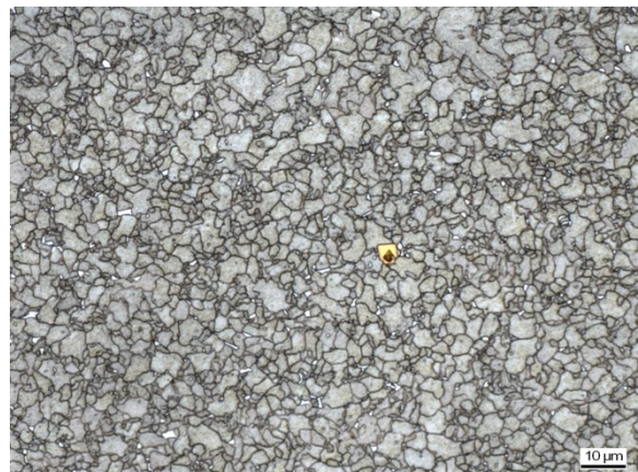
Abbildung C 114: WEZ Simulation (S 700MC, Blechdicke 10 mm), T_{\max}(1)=1101,7^{\circ}\text{C} , t_{8/5}(1)=24,4\text{ s} , T_{\max}(2)=750,0^{\circ}\text{C} , t_{8/5}(2)=25,0\text{ s}
