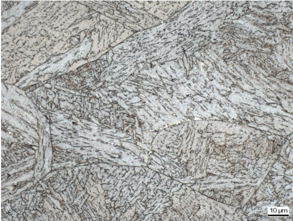
Abbildung C 109: WEZ Simulation (S 700MC, Blechdicke 10 mm), T_{\max}(1)=1170,7^{\circ}\text{C} , t_{8/5}(1)=28,5\text{ s} , T_{\max}(2)=1280,7^{\circ}\text{C} , t_{8/5}(2)=30,9\text{ s}
