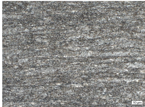
Abbildung C 90: WEZ Simulation (S 700MC, Blechdicke 12mm), T_{\max} = 594,1 \text{ }^\circ\text{C} , t_{8/5} = 8,1 \text{ s}
