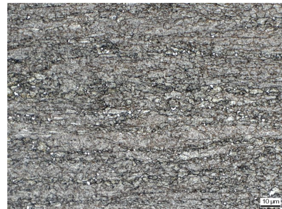
Abbildung C 84: WEZ Simulation (S 700MC, Blechdicke 12mm), T_{\max} = 788,1 \text{ °C} , t_{8/5} = 5,1 \text{ s}
