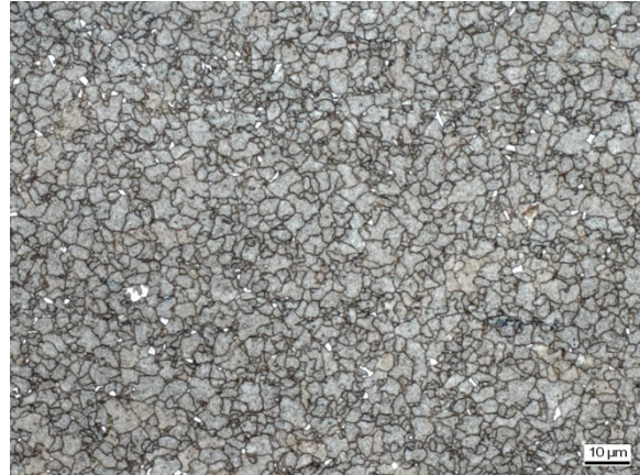
Abbildung C 116: WEZ Simulation (S 700MC, Blechdicke 10 mm), T_{\max}(1)=732,2^{\circ}\text{C} , t_{8/5}(1)=25,0\text{ s} , T_{\max}(2)=967,8^{\circ}\text{C} , t_{8/5}(2)=22,8\text{ s}
