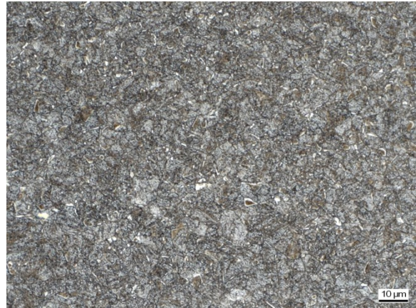
Abbildung C 76: WEZ Simulation (S 700MC, Blechdicke 12mm), T_{\max} = 1123,6 \text{ °C} , t_{8/5} = 5,5 \text{ s}
