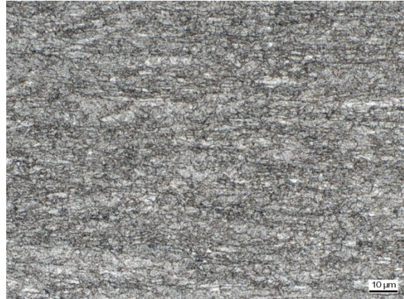
Abbildung C 92: WEZ Simulation (S 700MC, Blechdicke 12mm), T_{\max} = 381,9 \text{ °C} , t_{8/5} = 5 \text{ s}
