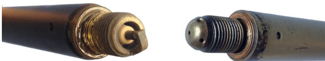
Abbildung 5.2.: Zündkerzentypen: Links: Standard Hakenkerze, Rechts: Vorkammerkerze
