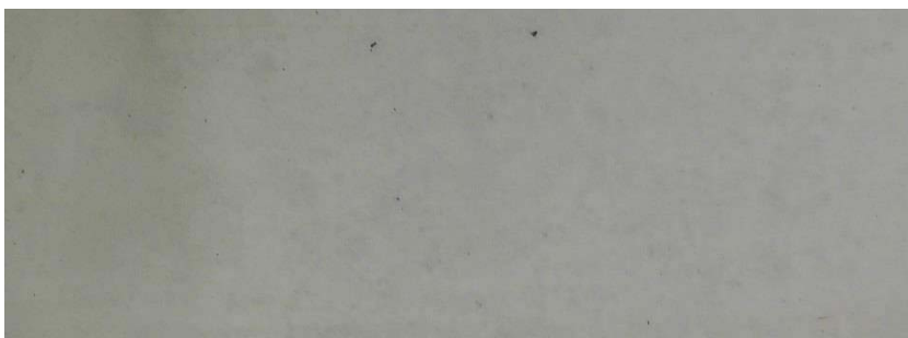
Abbildung 4.55 Porigkeit bei der ersten Verwendung der Schalhaut
