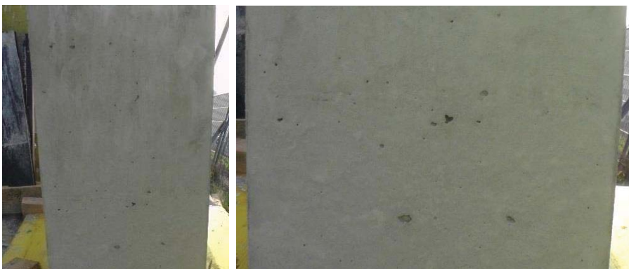
Abbildung 4.63 Versuchskörper 1 (2 Wochen nach Ausschalen)
