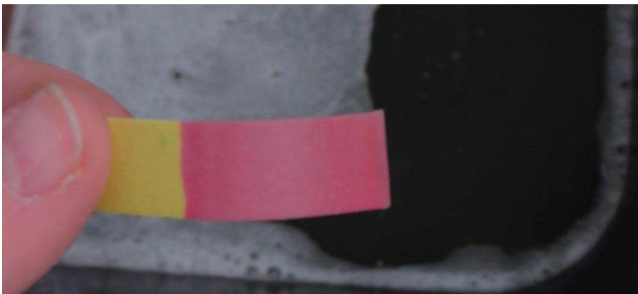
Abbildung 4.40 pH-Wert an der Schalhaut: ~2
