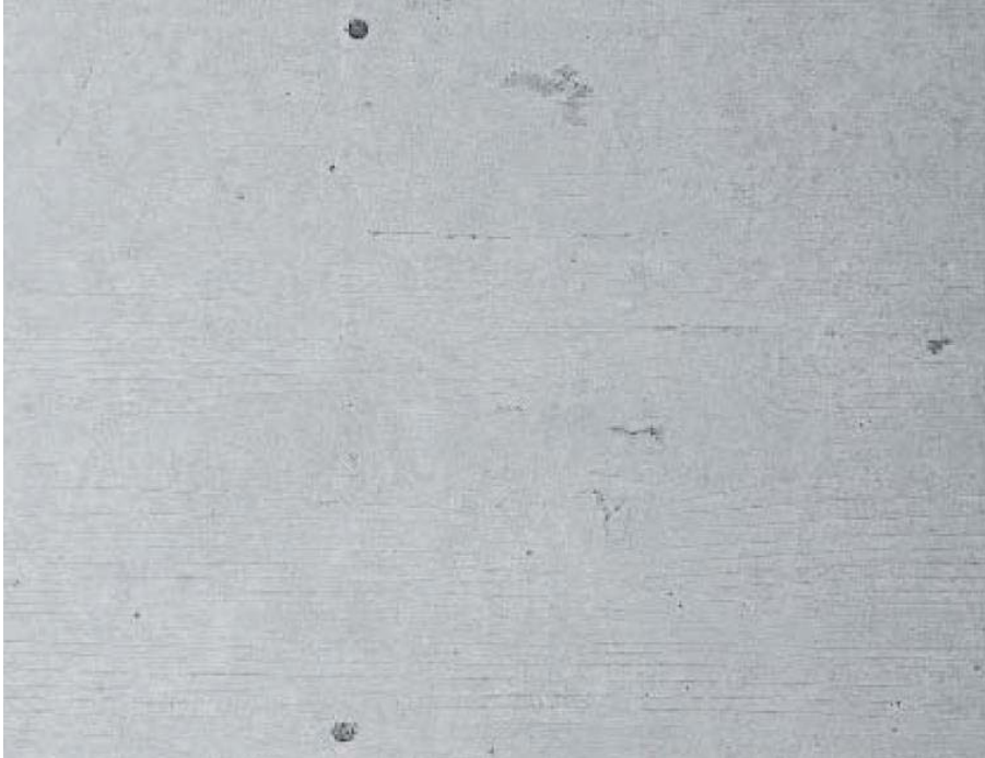
Abbildung 3.20 Textur T1 (3-Schicht-Platte)
