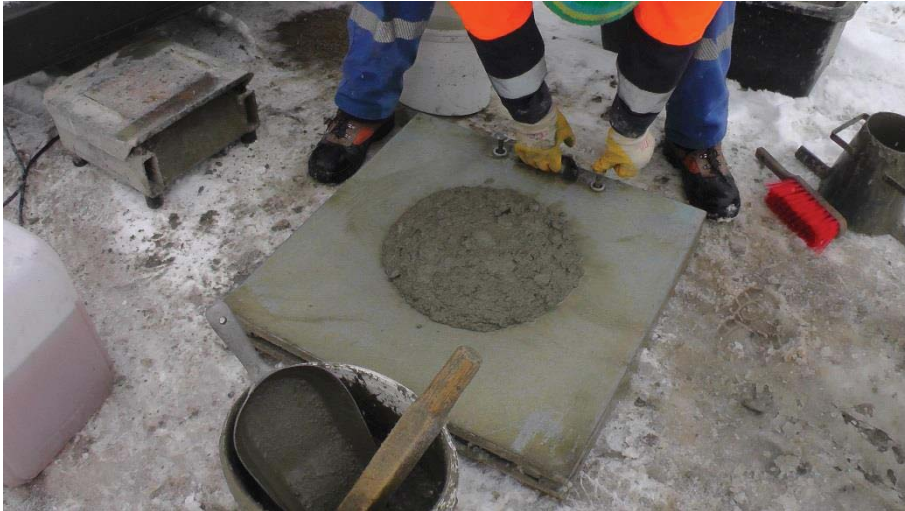
Abbildung 4.22 Testen Ausbreitmaß 11OGBT1
