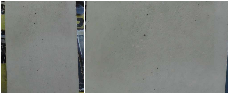
Abbildung 4.69 Versuchskörper 4 (2 Wochen nach Ausschalen)
