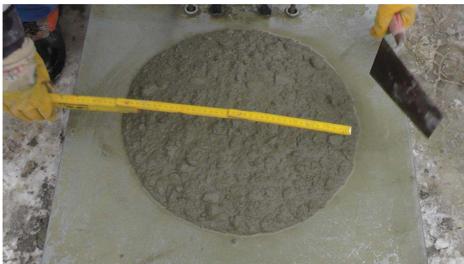
Abbildung 5.46 Bestimmung des Ausbreitmaßes
