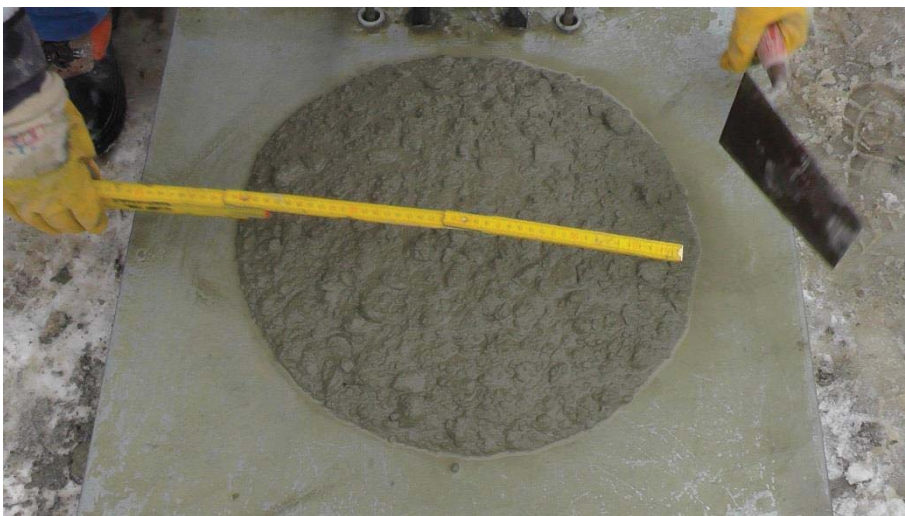
Abbildung 4.23 Ergebnis des Ausbreitmaßes 11. OG, Bauteil 1
