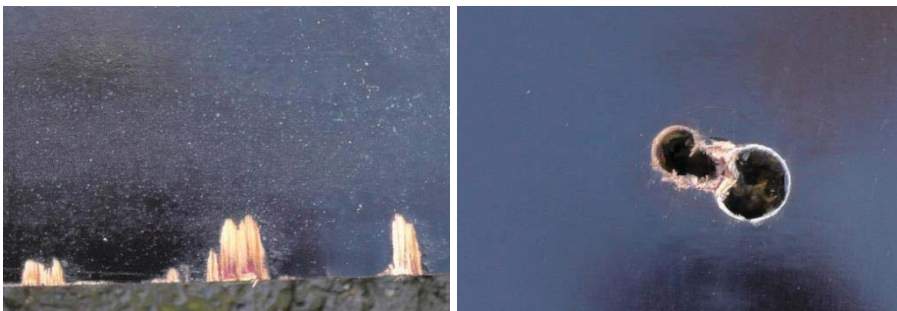
Abbildung 4.99 Schäden an der Schalhaut
