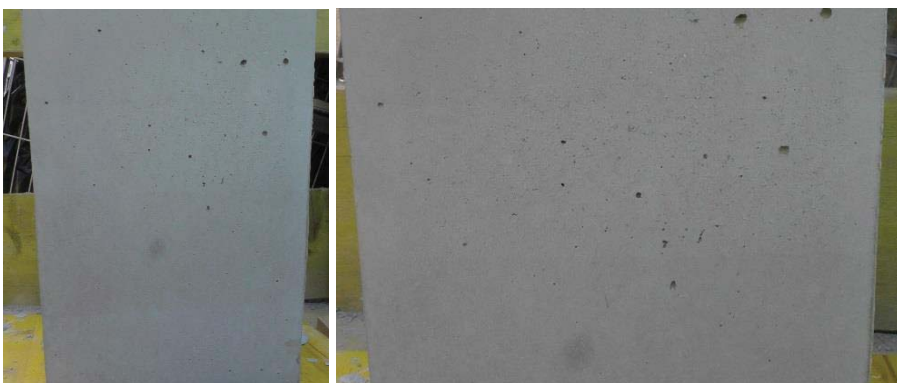
Abbildung 4.71 Versuchskörper 5 (2 Wochen nach Ausschalen)
