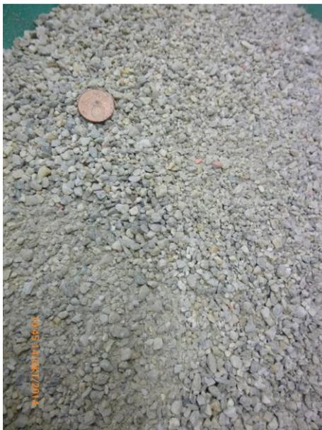
Abb. 22 Sandsackfüllung 02 Kies 2/4mm
