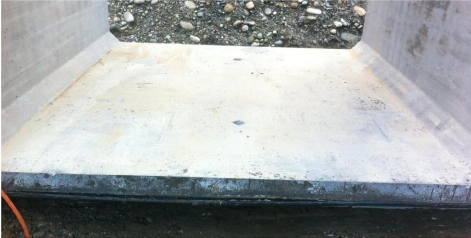
Abb. 63 gelöste Dichtung und 2 Ventillöcher nach Stellversuch
