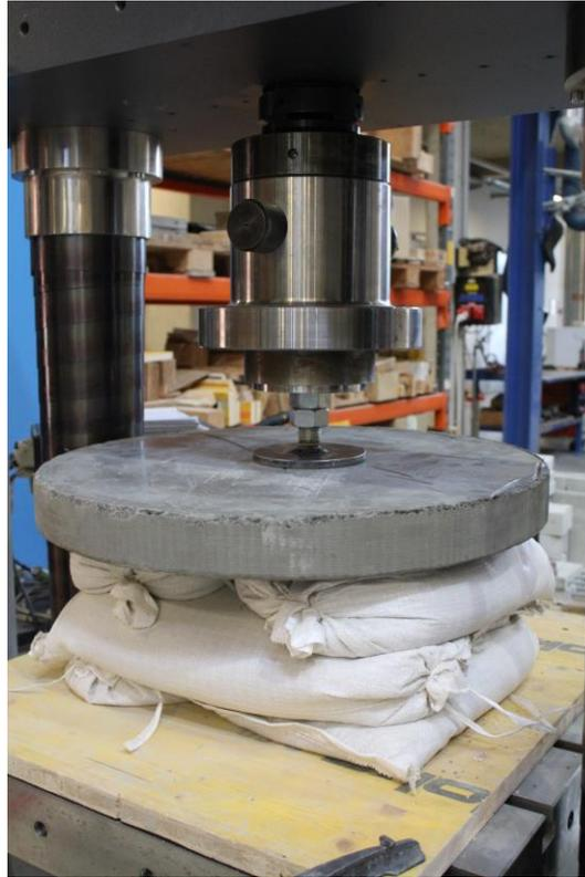
Abb. 38 Stapelversuch mit Stellfuß 50 kN
