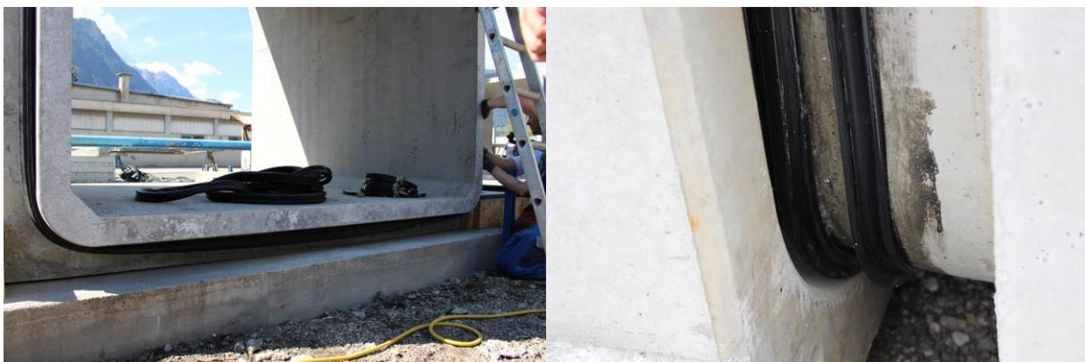
Abb. 62 Stellversuch Lienz Dichtung Fertigteile 09.09.2014
