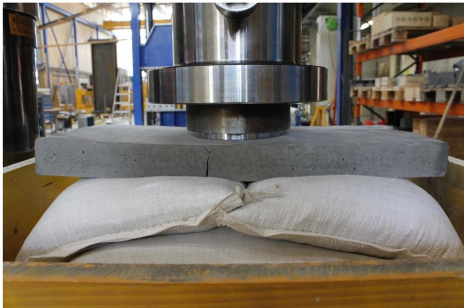
Abb. 32 Versagen der Lastplatte bei PP02S1L1
