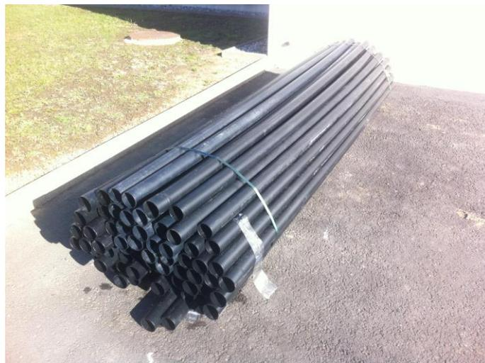
Abb. 79 PVC Schutzrohre
