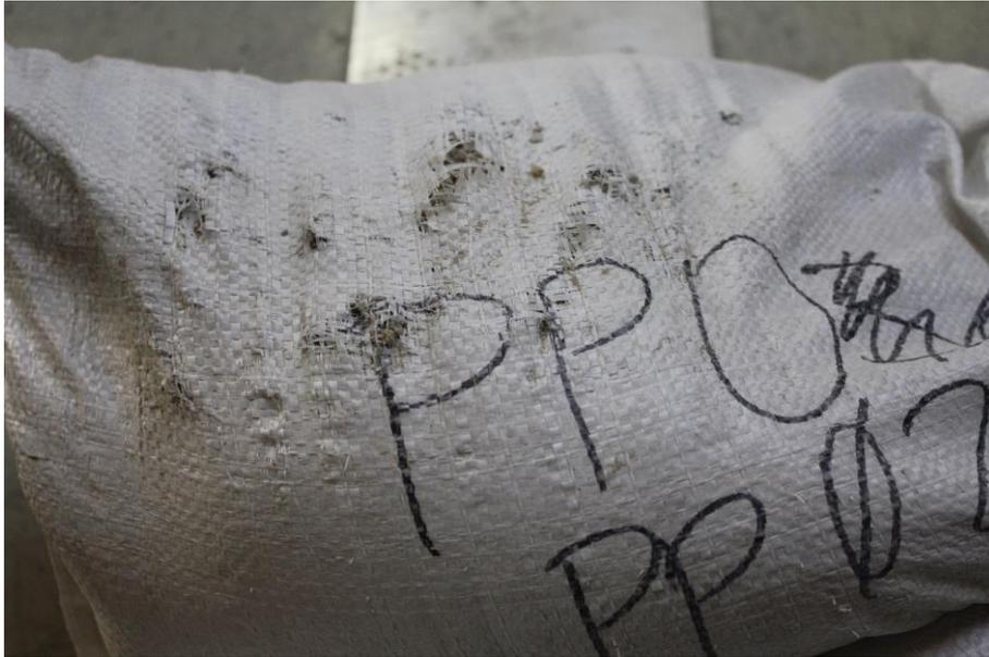
Abb. 36 Versagen an Unterseite PP-Schotter nach 100 kN Beanspruchung (PP02S1L2c)
