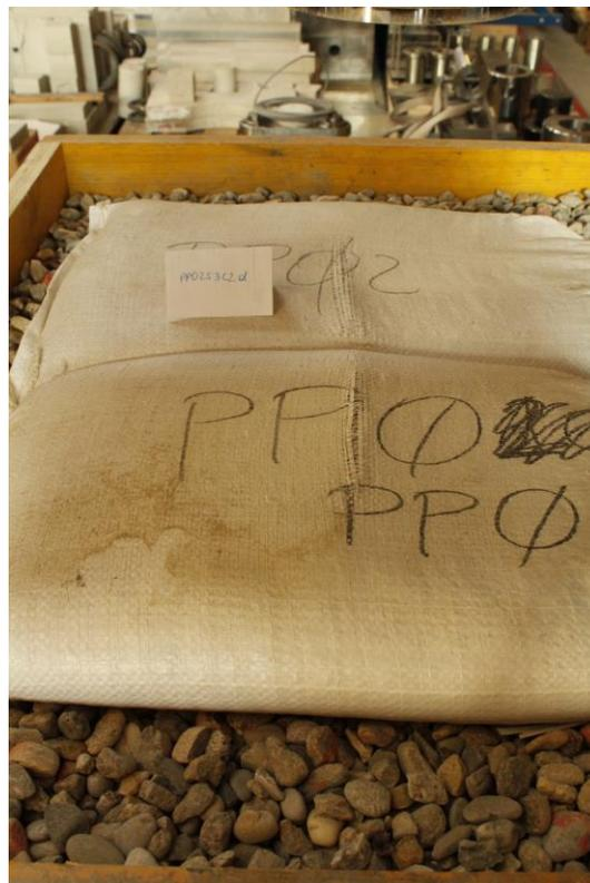
Abb. 37 Querrisse nach 100 kN Beanspruchung Kontaktflächen PP (PP02S3L2d)
