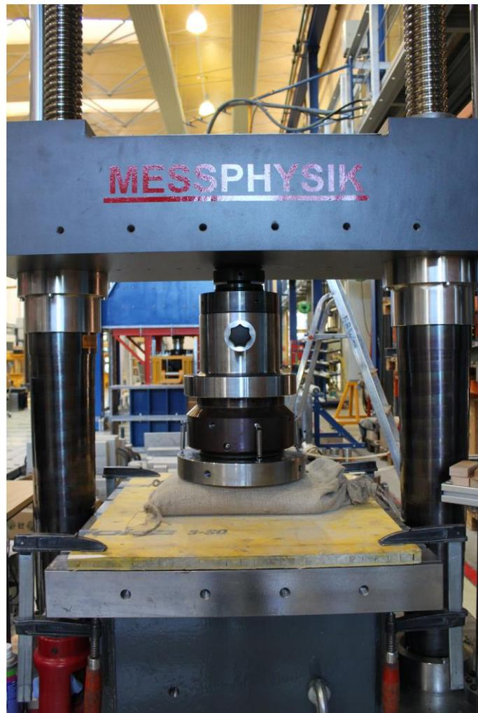
Abb. 26 Lastplattenversuch mit 300 mm Lastplatte
