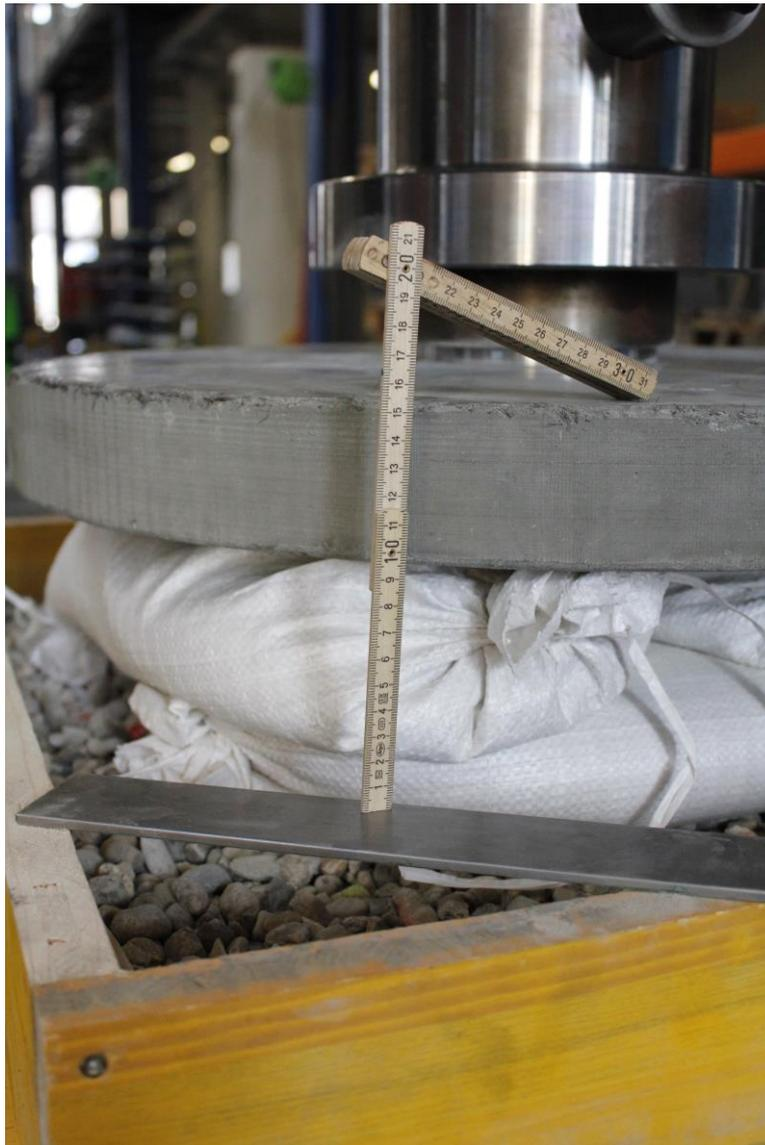
Abb. 35 Einbau Stapelungsversuch auf Schotterbett und Höhenabnahme PP02S1L2c
