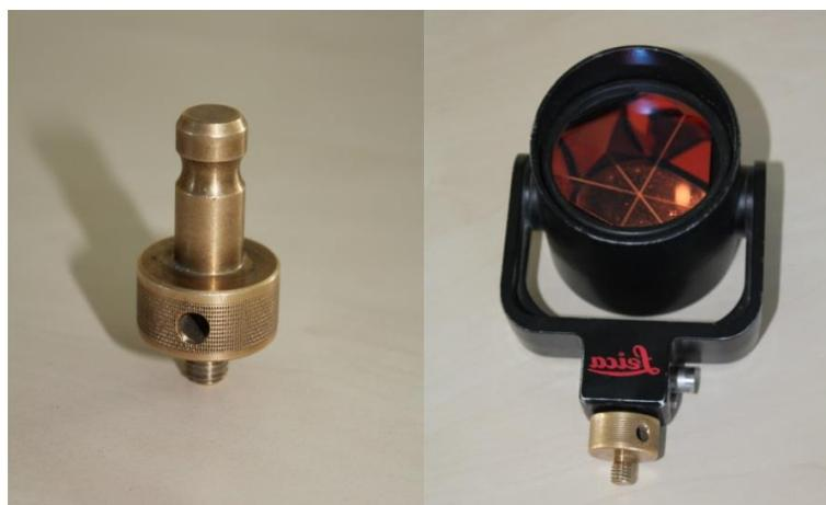
Abb. 75 M8 Gewindeaufsatz und Reflexionsprisma
