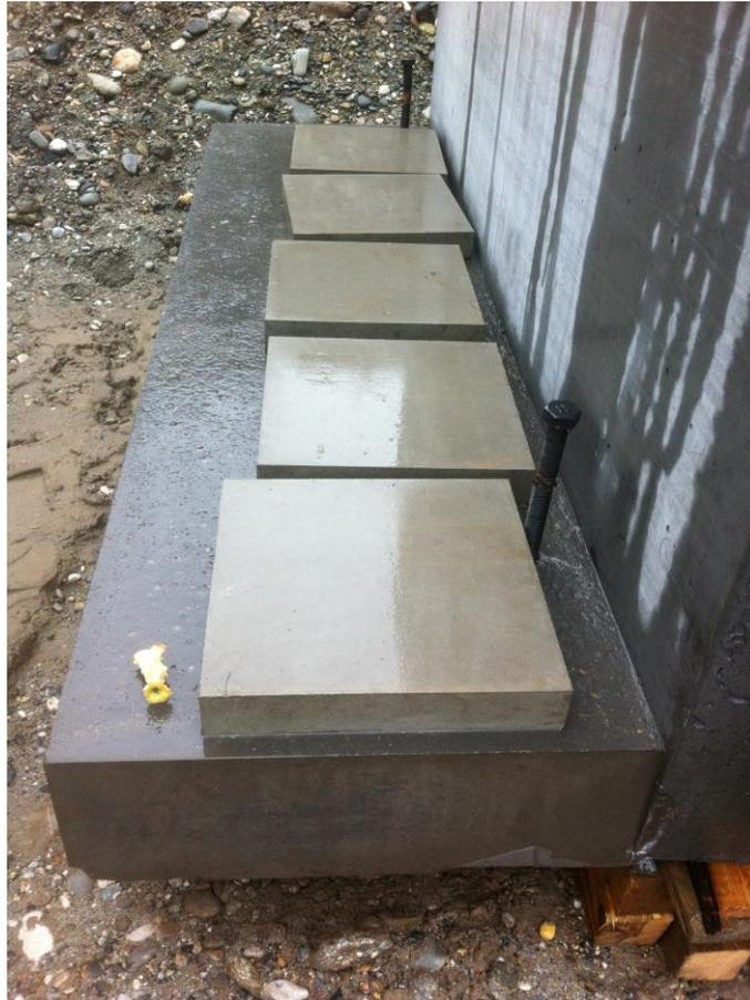
Abb. 41 Lasteinleitungsplatten bewehrt 45\*45\*7 cm
