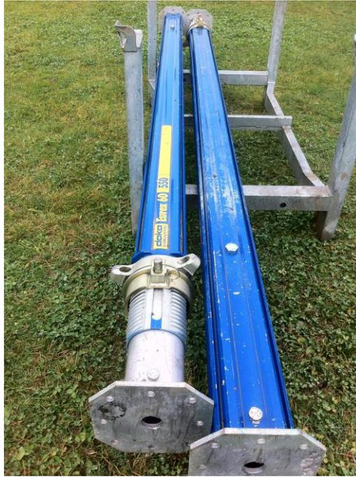
Abb. 13 Schwerlaststeher Doka zur Aussteifung der Spundwand
