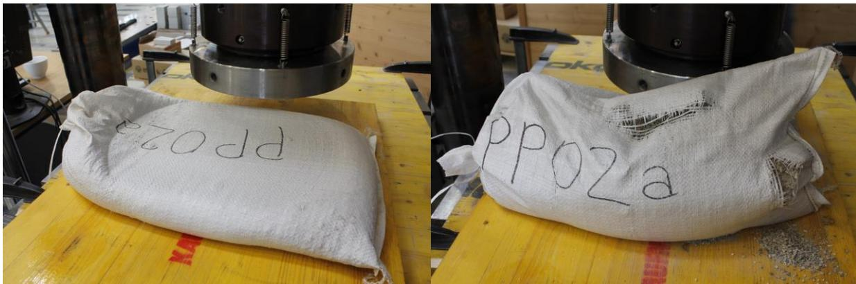
Abb. 30 PP02a nach 350kN Belastung; Längs- und Querrisse an der Unterseite
