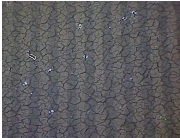
Abbildung 109: Oberfläche der PtCo beladenen GDE nach Auswaschen und Trocknen.
