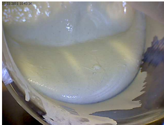
Abbildung 68: CMC haltige WO 3 Paste nach dem Dispergieren. Es kommt zur Ausbildung einer gelartigen Konsistenz
