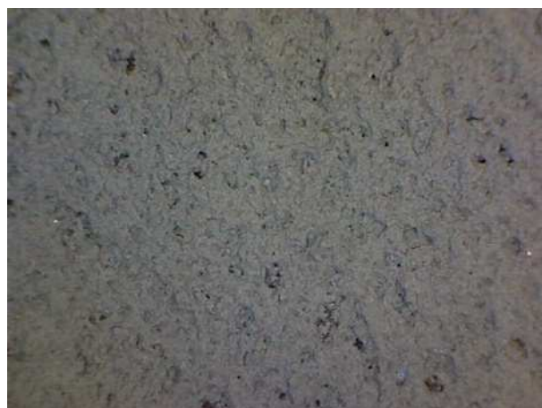
Abbildung 48: Oberflächenaufnahme einer CNF Schicht (HTF 150 FF LHT XT) mit einer Beladung von 10 \text{ mg}/\text{cm}^2
