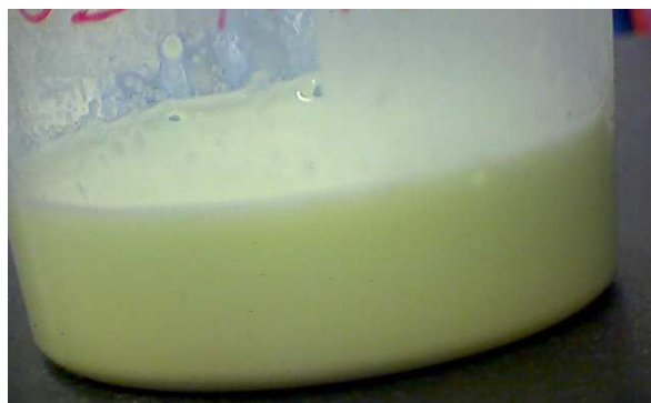
Abbildung 65: Aufnahme einer reinen \text{WO}_3 Paste mit der Zusammensetzung aus Tabelle 22.
