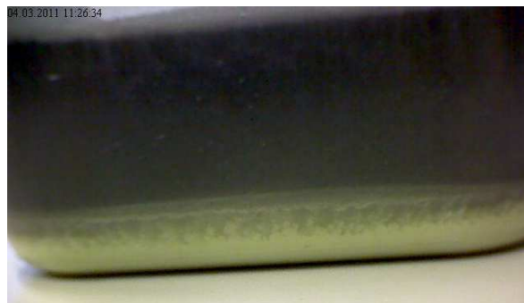
Abbildung 58: Entmischung der \text{WO}_3 Bestandteile aus der XC72 Paste. Aus diesem Grund musste die Paste innerhalb weniger Minuten zu einer GDE1 verarbeitet werden.
