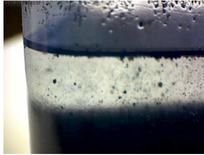
Abbildung 41: Entmischung der CNT Paste mit geringem CNT Anteil nach zwei Minuten.
