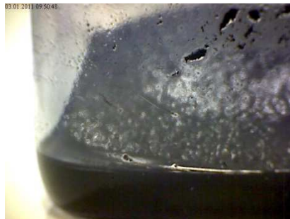
Abbildung 42: Entmischung der CNT Paste mit erhöhtem Trägermaterialanteil (7 Teile CNTs) nach zwei Minuten.
