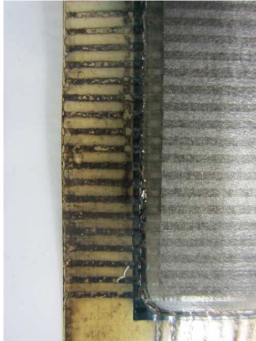
Abbildung 101: Detail der Randverstärkung der \text{WO}_3 basierten MEA nach dem Dauerbetrieb
