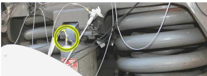
Abb. 03-04: Einsatz eines Shakers zur Bestimmung der TF, [SI]
