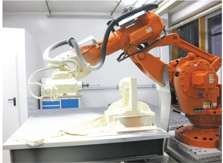
**Bild 250.** Fräsarbeiten im Roboter Design Labor.
