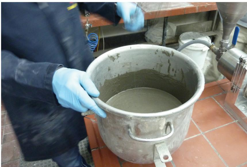
Bild 222. Mörtelmischung nach dem Mischen. Material kann für die Druckversuche verwendet werden.
