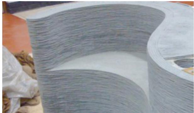
Bild 398. rechts, Concrete Printing, University von Loughborough
