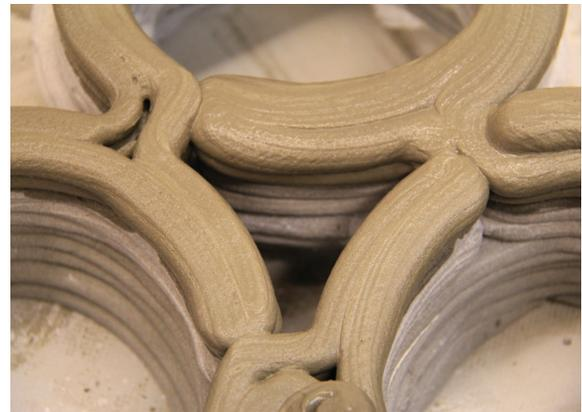
**Bild 332-335.** Beschädigung der Druckbahnen durch Lufteinschlüsse in der Mörtelmischung
