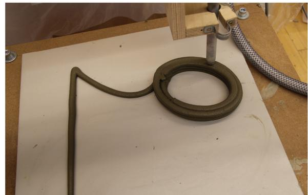
Bild 305-307. Zufahrt und Konsistenz des ersten elliptischen Basislayers
