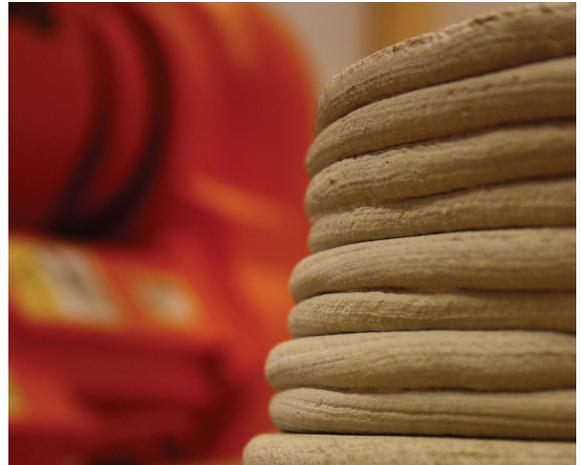
**Bild 363-367.** Betrachtung der verschiedenen Druckbahnen nach dem Aushärtungsprozess
