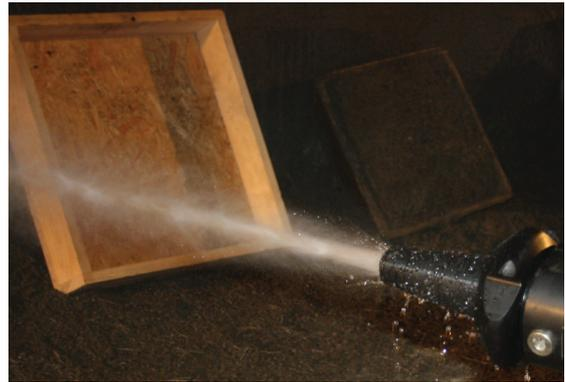
**Bild 113.** links, Die Düsenöffnung wurde zu klein ausgeführt.
