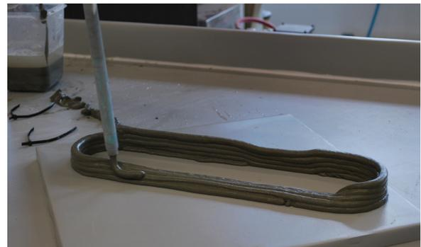
**Bild 287-291.** *Aufbauen der Schichten und Versagen der Stabilität*
