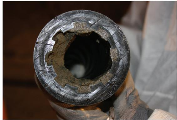
**Bild 115.** links und **Bild 116.** rechts, Durch die Verstopfung der Düse stieg der Druck im System an. Nach kurzer Verweildauer kam es zum Bruch des Materials.
