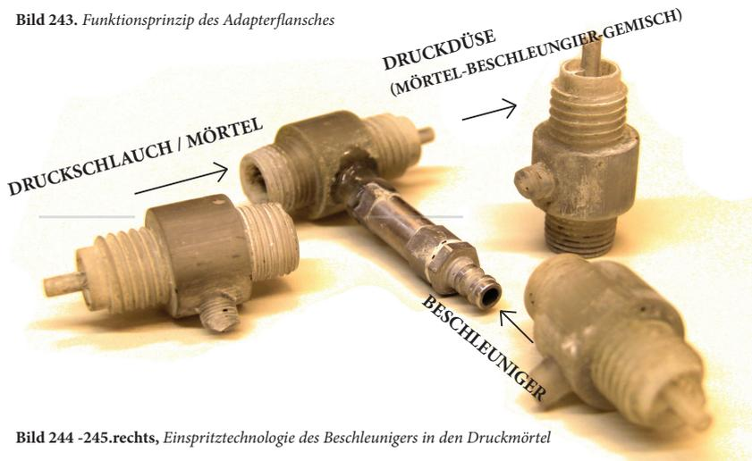
Bild 244 -245.rechts, Einspritztechnologie des Beschleunigers in den Druckmörtel
