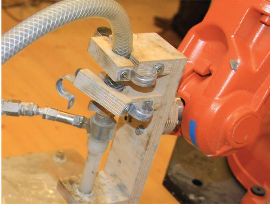
Bild 240. Befestigung des Druckschlauches und der Druckdüse am Roboterarm
