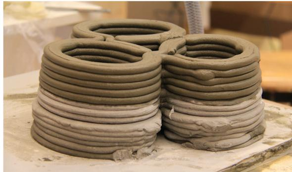
Die Wiederholung der Druckversuche benötigte eine längere Offenzeit des Druckmaterials. Aus diesem Grund wurde dem Mörtel intuitiv Wasser und Verzögerer beigemischt. Diese Handlung heißt in den nächsten Versuchen: *JE NACH GEFÜHL GESTEIGERT*.
