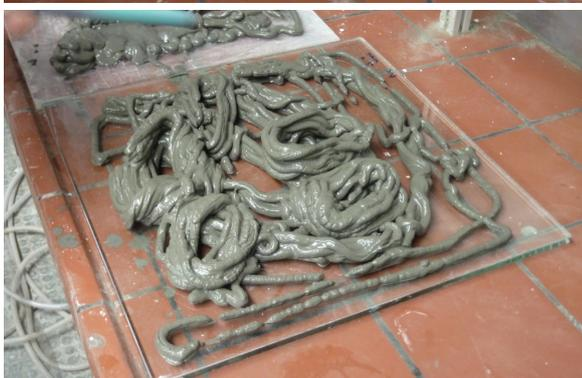
Bild 134. links, Durch Steigerung der Verfahrensgeschwindigkeit kann die Geometrie des Druckstranges verändert werden.
