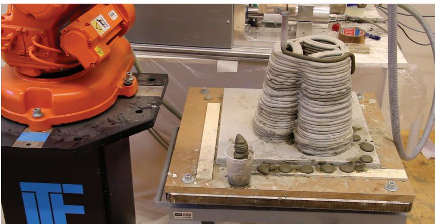
*Bild 354-356. Entwicklung des Druckmaterials beim Schließen des Betonknotens zu einer Kreisform*
