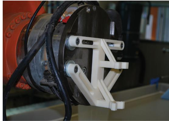
**Bild 136.** links Befestigung der Druckdüse am Roboterarm
