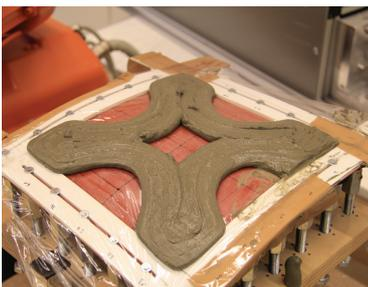
Man sollte sich bereits im Entwurfsprozess Gedanken über die Positionierung der Druckbahnen in Abhängigkeit der Formstabilität machen. Mit Hilfe von anderen Errungenschaften im Bereich der automatisierten Fertigung, sollte eine Optimierung der Oberfläche und Maßgenauigkeit erreicht werden. Ein 3D Scanner könnte die realisierten Druckbahnen in Echtzeit erfassen, Fehler erkennen und mittels eines zweiten Roboterarms ausbessern.
