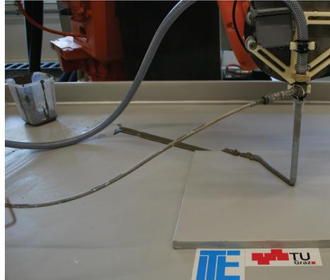
**Bild 236.** Verbindung zwischen Beschleunigereinheit und Druckdüse
