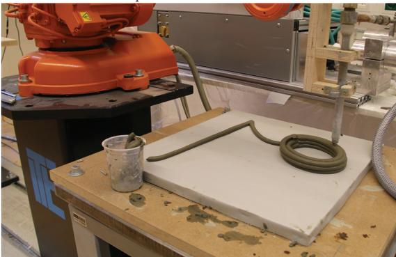
**Bild 253.** Drucken von Radien und Aufbauen von Schichten
