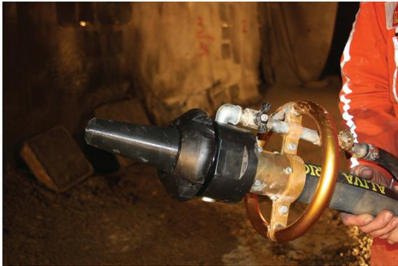
**Bild 112b.** rechts, Verhalten der Düse während des Spritzens. Das Druckmaterial der 3D gedruckten Düse ist nicht dicht und das Wasser entweicht.
