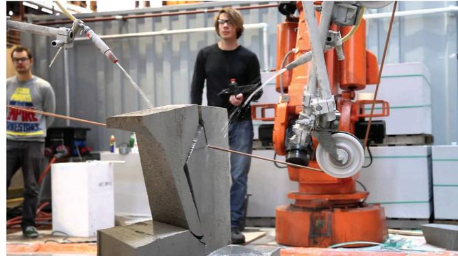
**Bild 26.** rechts, Automatisierte Betonschneidarbeiten mittels Diamantdraht.
