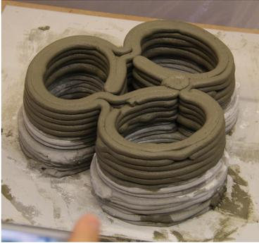
Um sich den Abläufen des 3D Drucks anzunähern und das System zu verbessern, sollte der automatisierte Fertigungsablauf gesteigert werden, indem die Dosierung und die Aufbereitung der einzelnen Mörtelkomponenten in die Prozesskette integriert werden.
