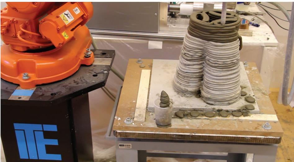
*Bild 360-362. Entwicklung des Druckmaterials beim Schließen des Betonknotens zu einer Kreisform*
