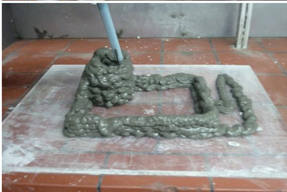
Bild 132. links, Schichtenweises Auftragen des Druckmaterials.
