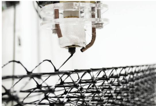
**Bild 34.** links, Frei beweglicher Industrieroboter webt Polymernetz
