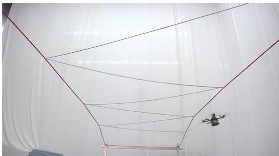
Bild 49. Flugdrohne flechtet eine Tragstruktur aus Kunststoffen.
