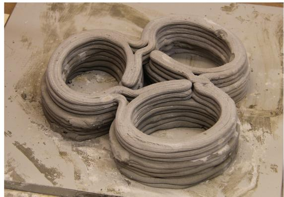
**Bild 326-330.** Interessanter Druckverlauf beim Verbinden der Basislayer
