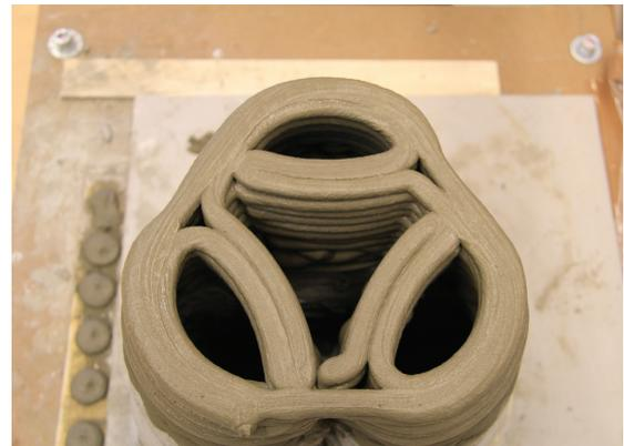
**Bild 351-353.** Unterschiedliche Struktur der Druckbahnen durch fehlende Befestigung der Druckkammer
