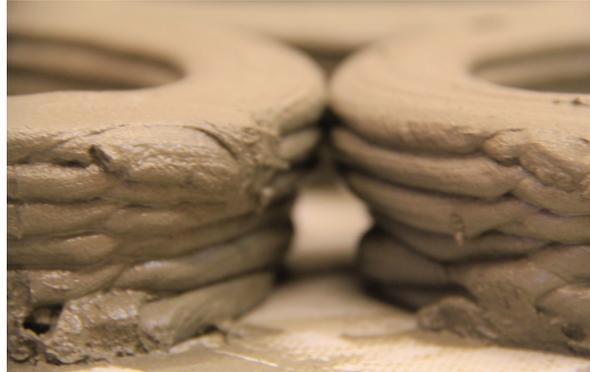
**Bild 320-325.** Darstellung der Oberflächenbeschaffenheit und Auskrugung der einzelnen Druckschichten.
