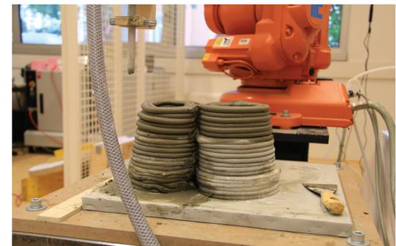
Bild 341-345. Fehlstellen werden durch folgende Druckbahnen korrigiert.
