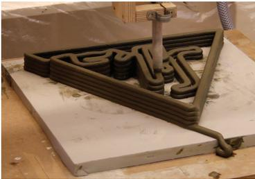
Im Bereich der Betonchemie muss noch genauer geforscht werden, da die Mörtelkomponenten, der Beschleuniger, die Temperatur und der Luftdruck großen Einfluss auf die Maßgenauigkeit, die Festigkeit und die Rissbildung haben.
