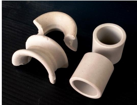
Abbildung 3-4: Füllkörper eines Schüttgutfestbetts. Links ein keramischer-Sattelkörper, rechts ein Raschig-Ring.
