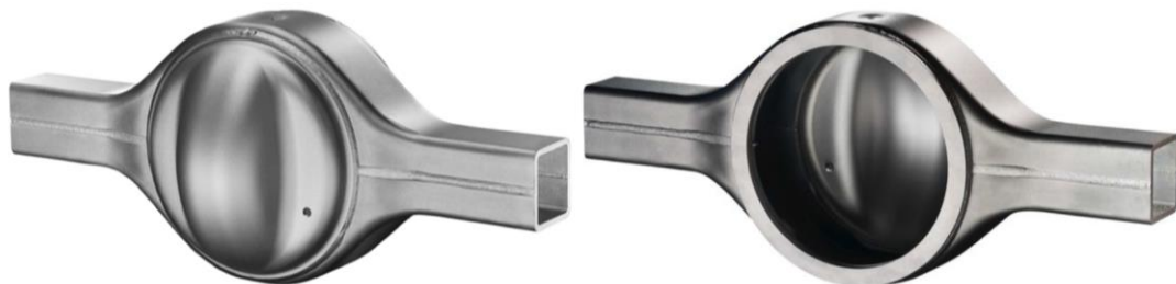
Abbildung 3.1: Auslieferungszustand Achsbrücke, links Deckelseite, rechts Ringseite (voestalpine Anarbeitung GmbH, 2014)
