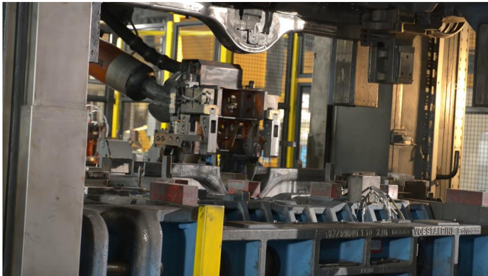
Abbildung 3.13: Entnahme der umgeformten Platine (voestalpine Anarbeitung GmbH, 2014)
