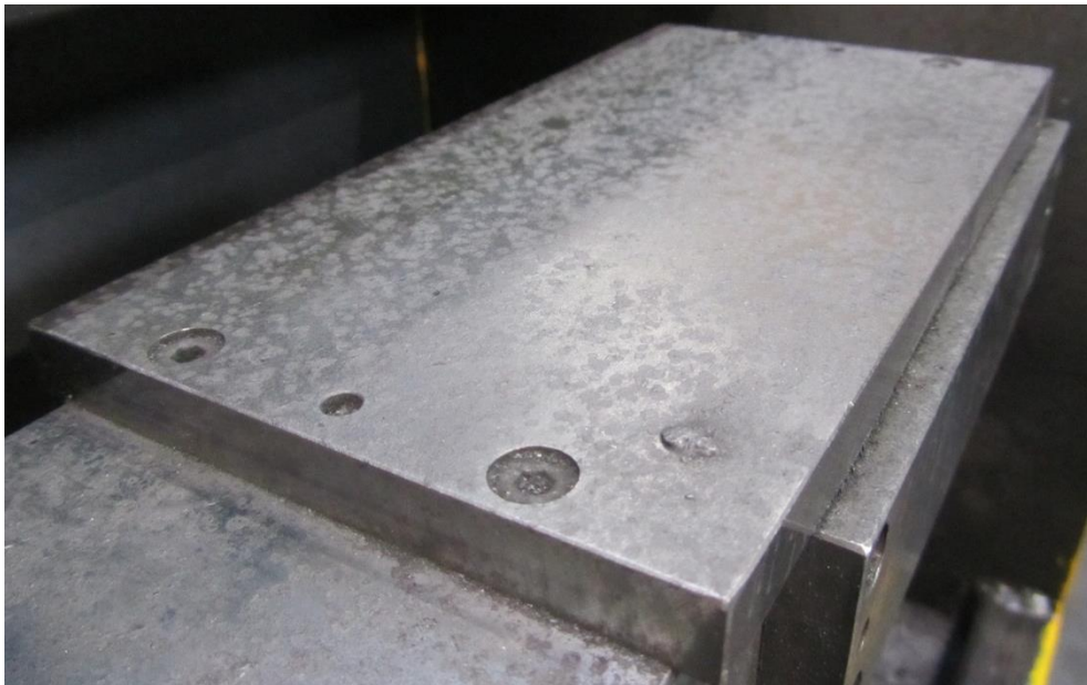
Abbildung 5.31: Verunreinigte Oberfläche Meisterteil
