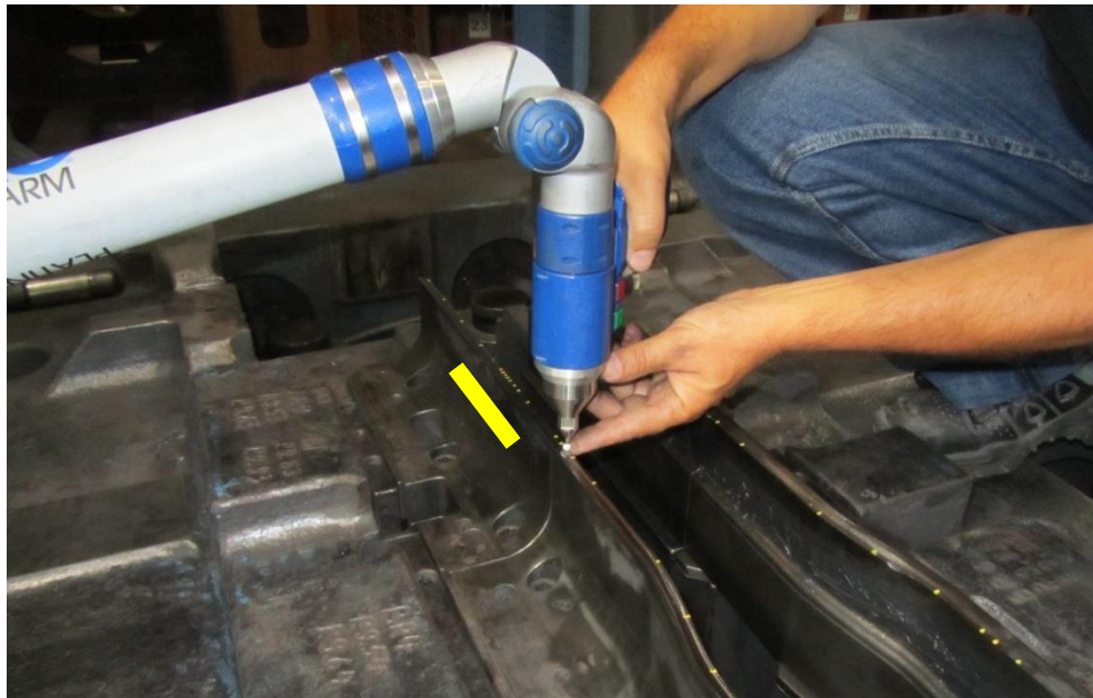
Abbildung 5.23: Vermessung der Prägeleistenhöhen mit Messarm
