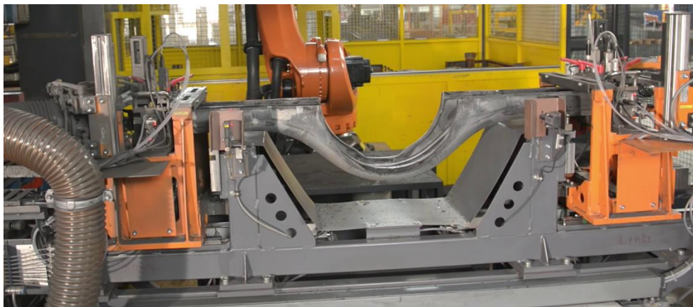
Abbildung 3.14: Vermessen der Halbschale (voestalpine Anarbeitung GmbH, 2014)
