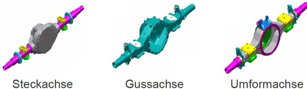
Abbildung 1.2: Verschiedene Bauarten der Achsbrücke (Kriegner, 2012, S. 4)
