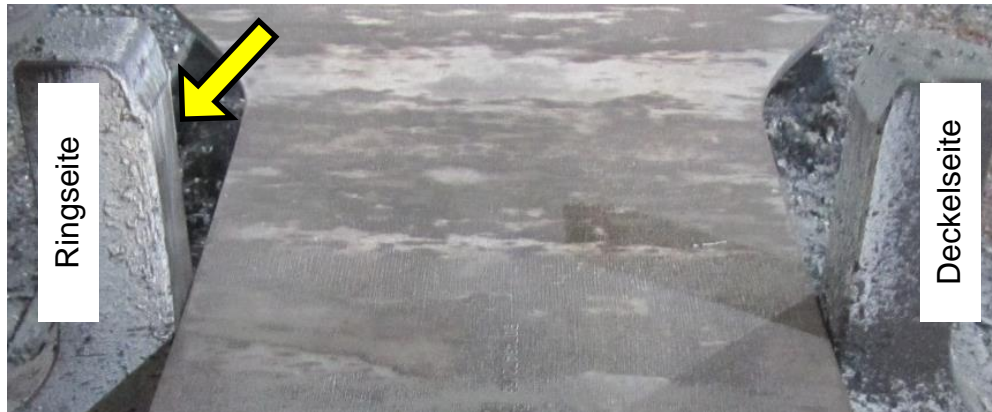
Abbildung 5.13: „Y-Seite“ einer erwärmten Platine BR4 im Werkzeug
