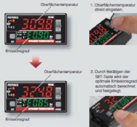
Abbildung 0.10: Einstellung des digitalen Verstärkers für den Infrarotsensor FT-H40K (Keyence Corporation)
