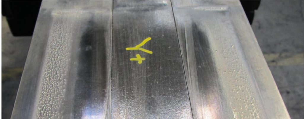
Abbildung 5.18: Verschleiß am Luftboden BR6 („Y+ Seite“)
