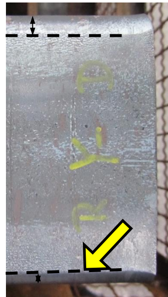
Abbildung 5.11: Square Edge „Y-Seite“ BR4: Ringseitig stärkere Stauchung
