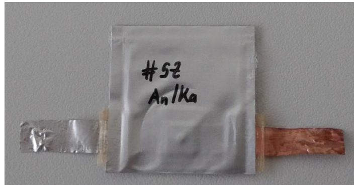
Abbildung 32: Probe mit Ersatzelektrolyt DEC
