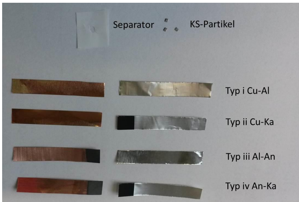
Abbildung 31: Umsetzung der Kurzschlusszenarien bei den Proben
