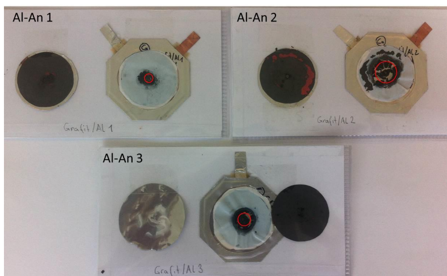
Abbildung 40: Post-mortem Analyse der Kurzschlussproben
