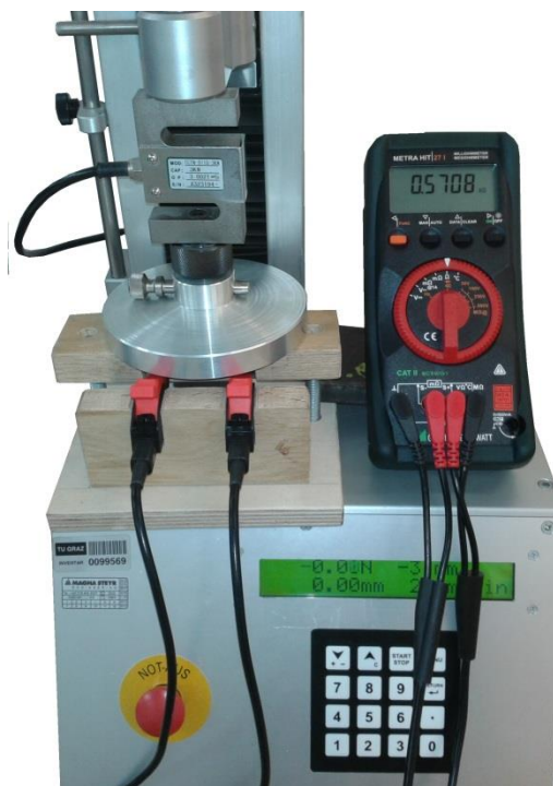
Abbildung 34: Versuchsaufbau der Übergangswiderstandsmessung
