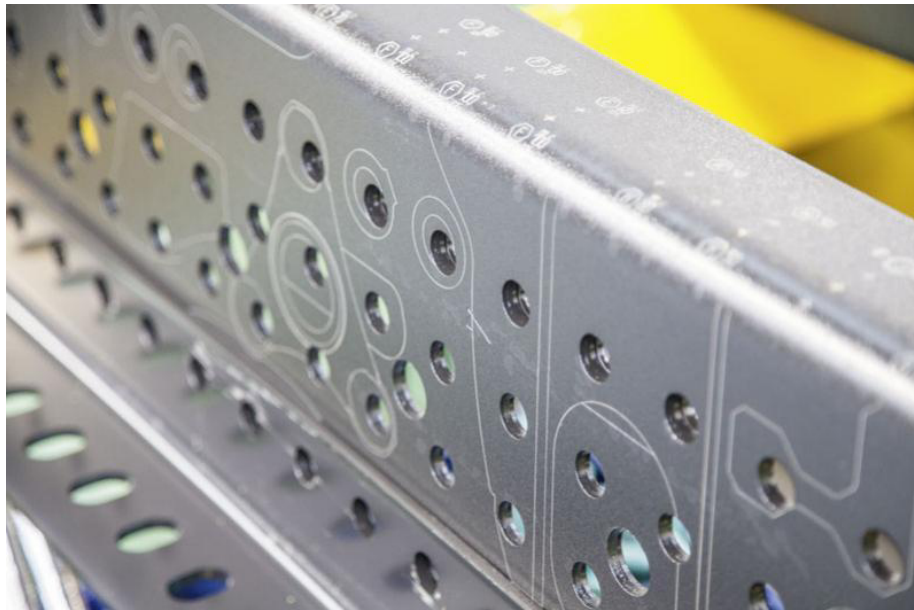
Abbildung 8: Lochbild am Rahmen eines Mercedes LKWs 36
