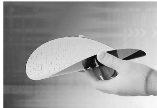
Abb. 2 - 300mm Dünnschicht Wafer<sup>2</sup>
