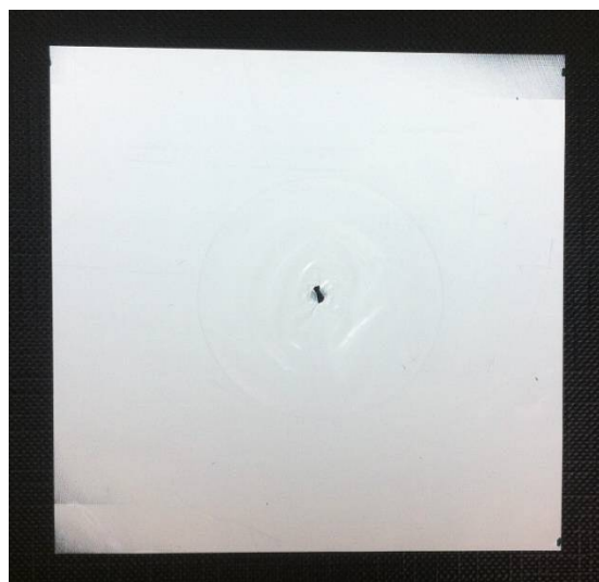
Abbildung 32 Mikroporöser Polymerseparator nach dem Puncture Penetration Test mit Loch in Probenmitte
