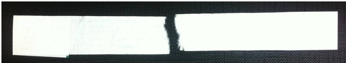
Abbildung 29 Vliesstoffseparator nach dem Zugversuch mit Bruch in der Probenmitte
