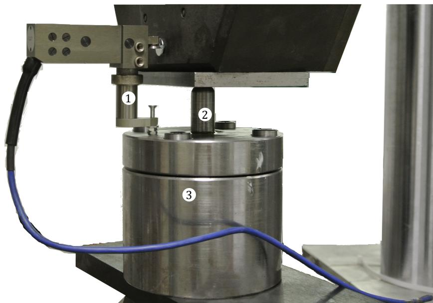
Abb. 5.2.: Versuchsaufbau des Sonderversuches zum Kopfzugversagen, ① Wegaufnehmer, ② Stempel, ③ Versuchseinrichtung
