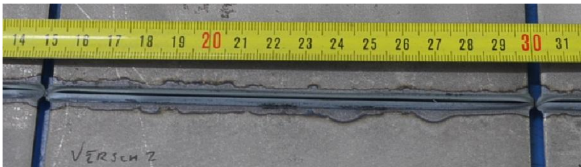
Abbildung 3-3: Auf der Ideal AS 100S PS/ABS Anlage presstumpfgeschweißte Naht [Kičin M.].
