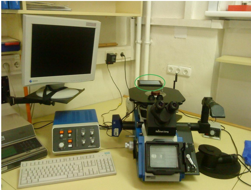
Abbildung 4-2: Lichtmikroskop (Reichert-Jung, MeF3) mit aufgesetztem Prüfgerät zur Mikrohärtprüfung (grüner Kreis).
