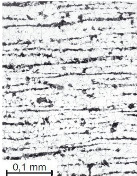
Abbildung 2-7: Lichtmikroskopische Aufnahme des Gefüges vom S355J2+N Stahl [1, p. 204].
