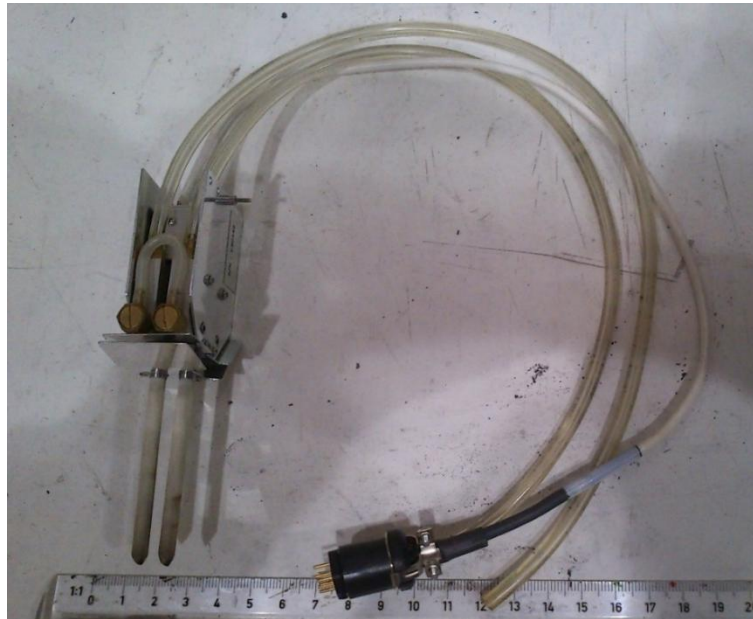
Abbildung 4-14: Feindehnungsaufnehmer aus Quarzglas zur Erfassung der Längenänderung.
