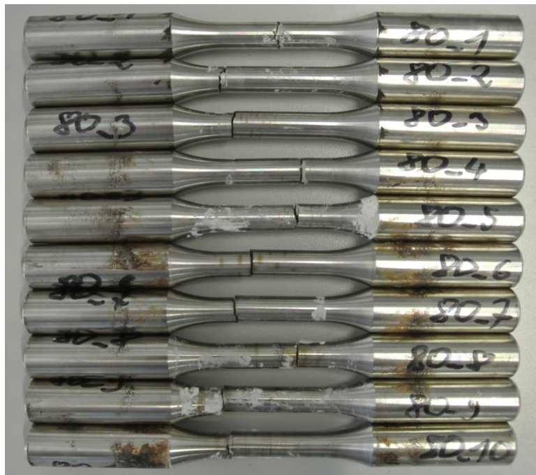
Abbildung 56: Gebrochene Proben mit Medium bei einer Temperatur von 80°C
