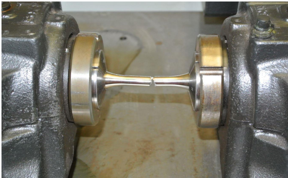
Abbildung 25: Bruch einer UBM-Probe nach 143418 Lastwechseln und einer Spannung von 690 MPa
