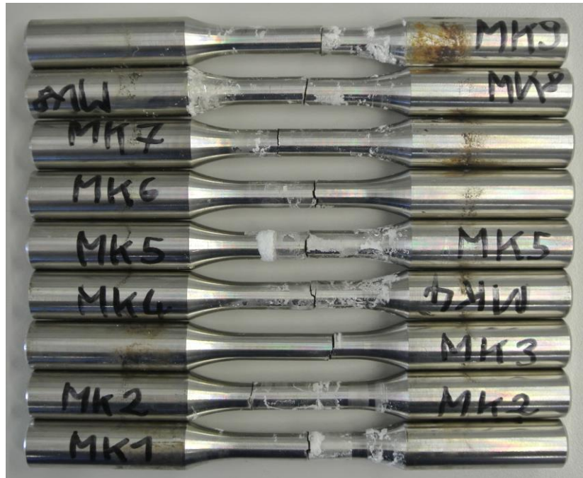
Abbildung 54: Gebrochene Proben mit Medium bei einer Temperatur von 40 - 45°C
