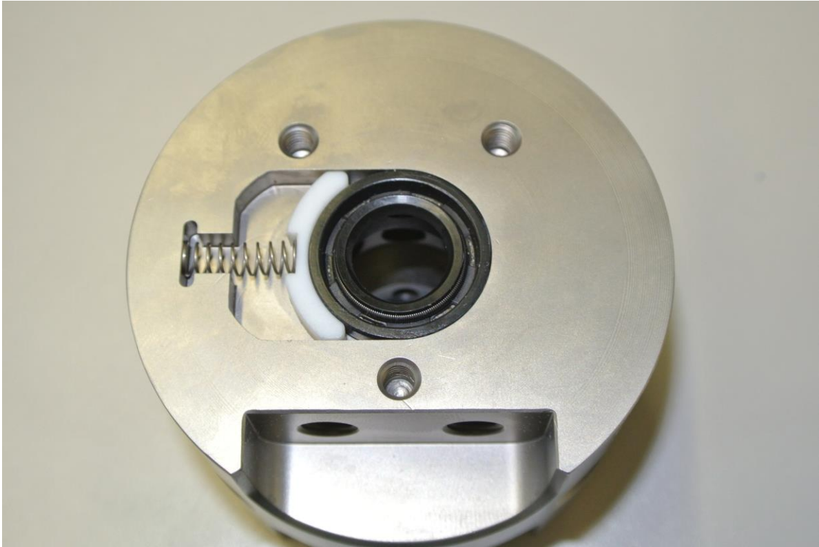
Abbildung 59: Federgelagerte Dichtung in Prüfkammer
