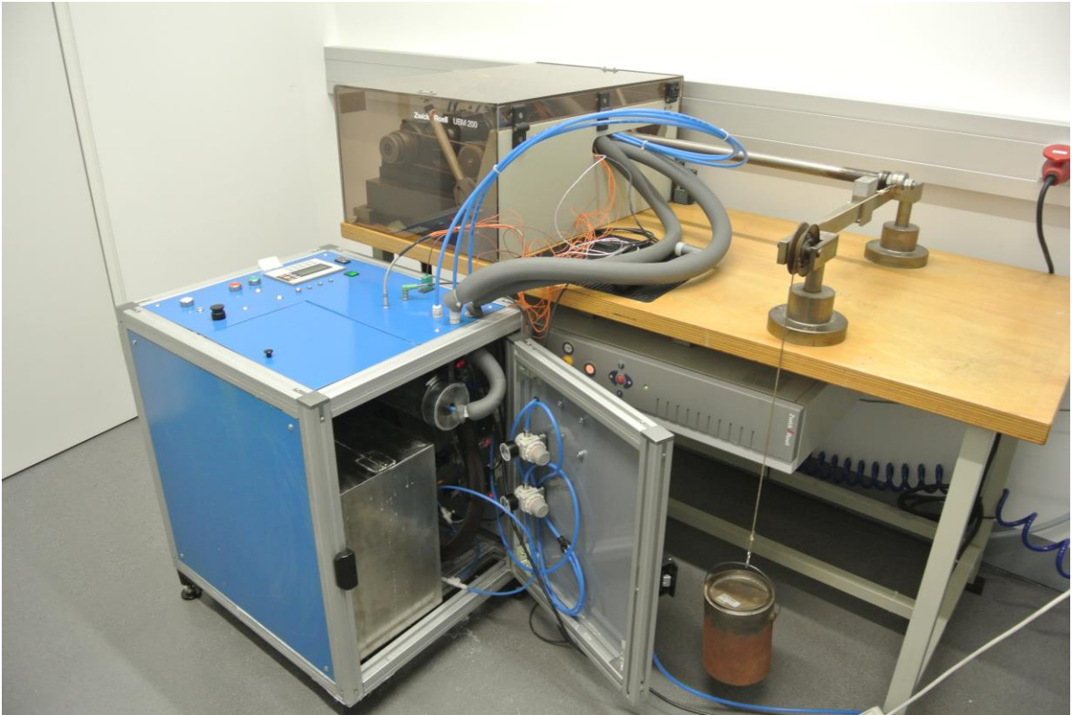
Abbildung 68: Gesamtes Prüfsystem (SPS-Steuerung) für Prüfkammer mit Umlaufbiegeprüfmaschine
