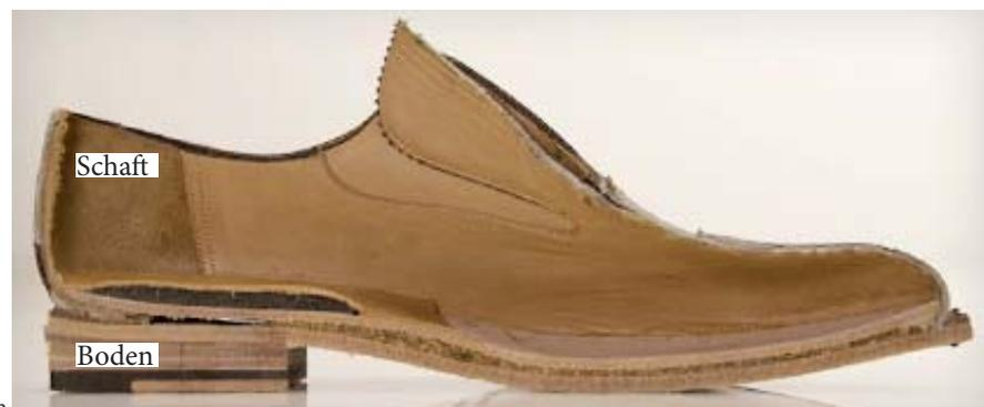
**Bild 25:** Schnitt durch einen herkömmlichen Schuh.<sup>28</sup> Vgl. Choklat 2013, 30 f.
