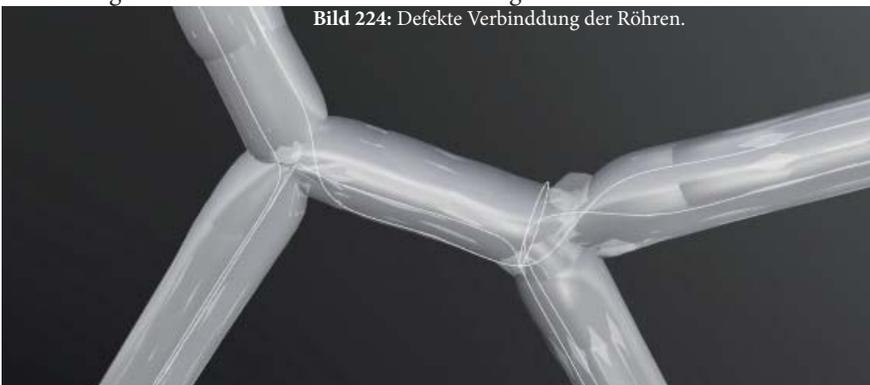
Bild 224: Defekte Verbindung der Röhren.
