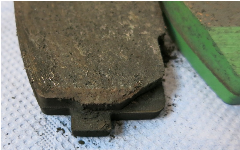
Abbildung 5-9 Ablagerungen am Scheibenauslauf
