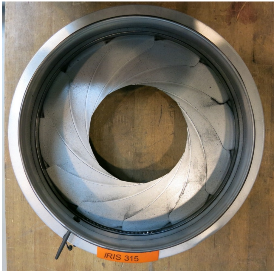
Abbildung 5-1 Verschmutzung der Lamellen der Irisblende
