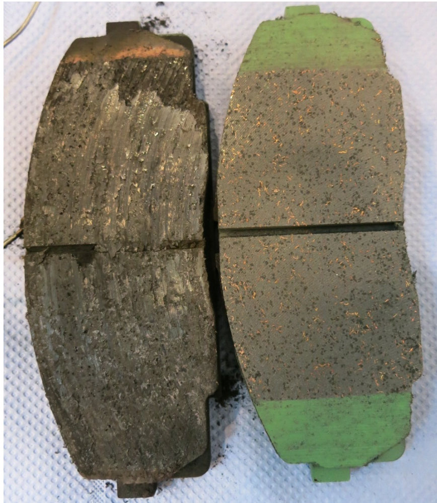
Abbildung 5-8 Vergleich benutzter und neuer Bremsbelag
