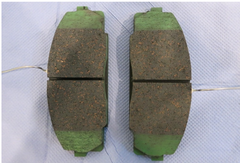
Abbildung 4-10 Bremsbeläge bestückt mit Temperaturfühler
