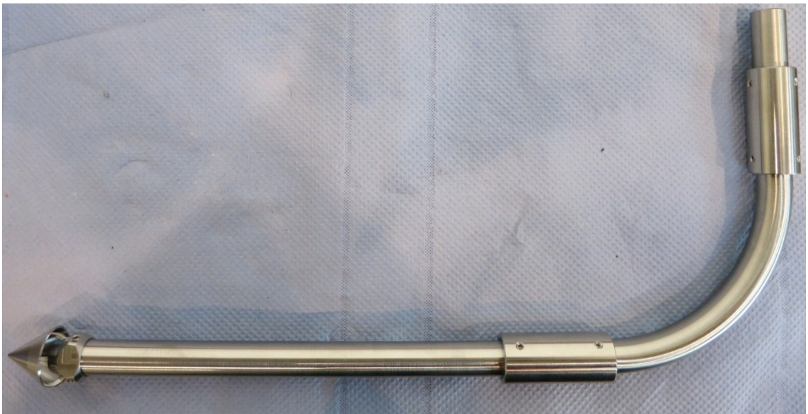
Abbildung 4-11 Entnahmesonde mit Sondenspitze nach ECE R83
