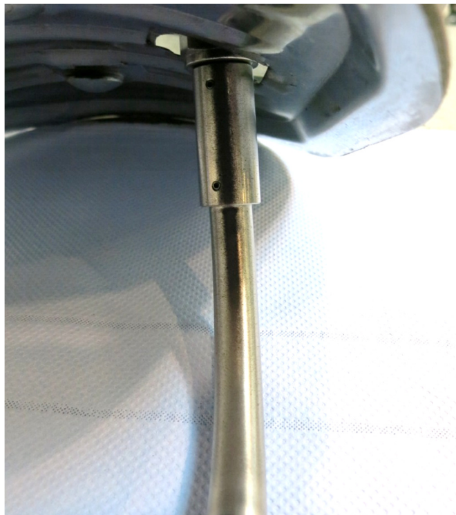
Abbildung 5-4 Verschmutzung der Entnahmesonden
