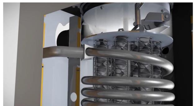
Abbildung A.10.: Oberer Teil der Rohrschlange im Wärmeübertrager
