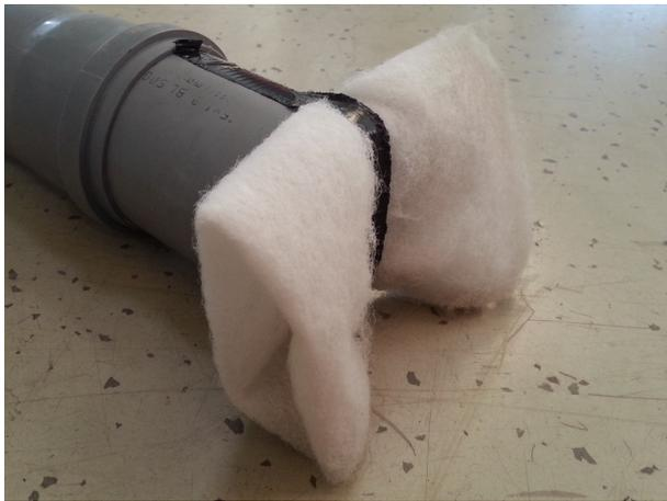
Abbildung A.15.: Abdeckung der Luftzufuhr für die Brennstoffbettmodellierung mit kurzzeitigen Luftsprüngen nach unten
