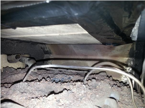
Abbildung A.13.: Abdeckung der Primärluftstrecke an der Unterseite des Schamotts für den Kaltversuch I
