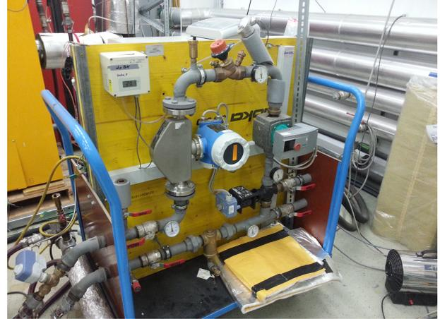
Abbildung A.12.: Hydraulikprüfstand zur Simulation des Verbrauchers
