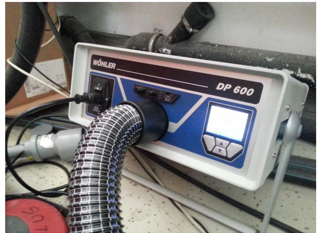
Abbildung A.16.: Externes Gebläse für die Brennstoffbettmodellierung mit kurzzeitigen Luftsprüngen nach oben
