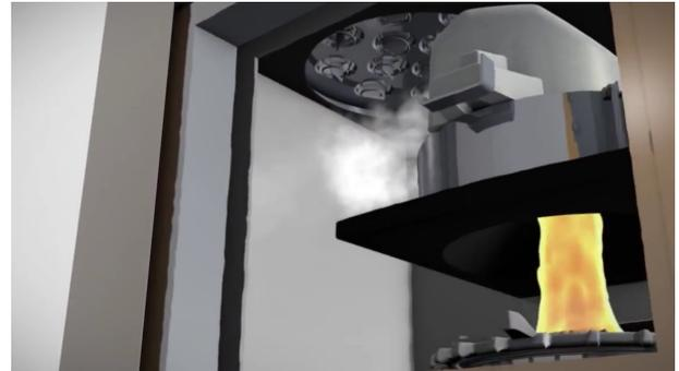
Abbildung A.8.: Weg des Rauchgases von der Primär- über die Sekundärverbrennungszone mit dem Zyklonenabscheider in den Wärmeübertrager
