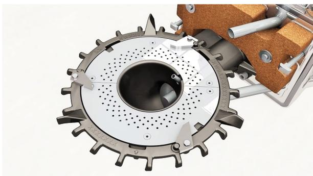
Abbildung A.3.: Drehrost mit Luftlöchern und Zündvorrichtung
