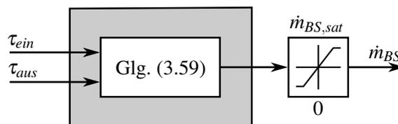
Abbildung 3.14.: Systemtechnische Darstellung der Brennstoffzufuhr
