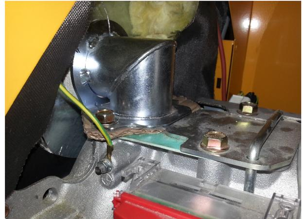
Abbildung A.14.: Abdeckung der Sekundärluftstrecke für den Kaltversuch II
