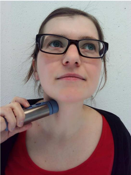
(a) Conventional EL device: Servox Digital (Servona).
