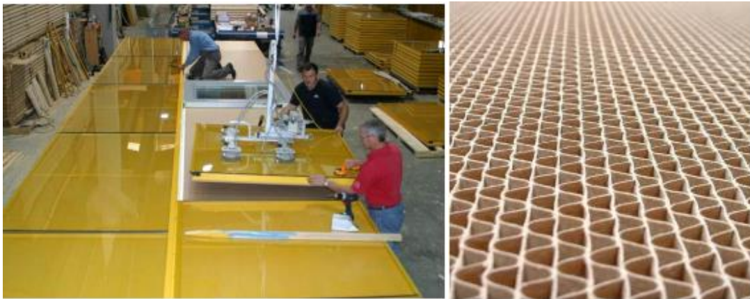
Abbildung 3-2: Fertigung Fassadenmodul GAP:Skin (links); Aufbau Solarwabe (rechts) [33]
