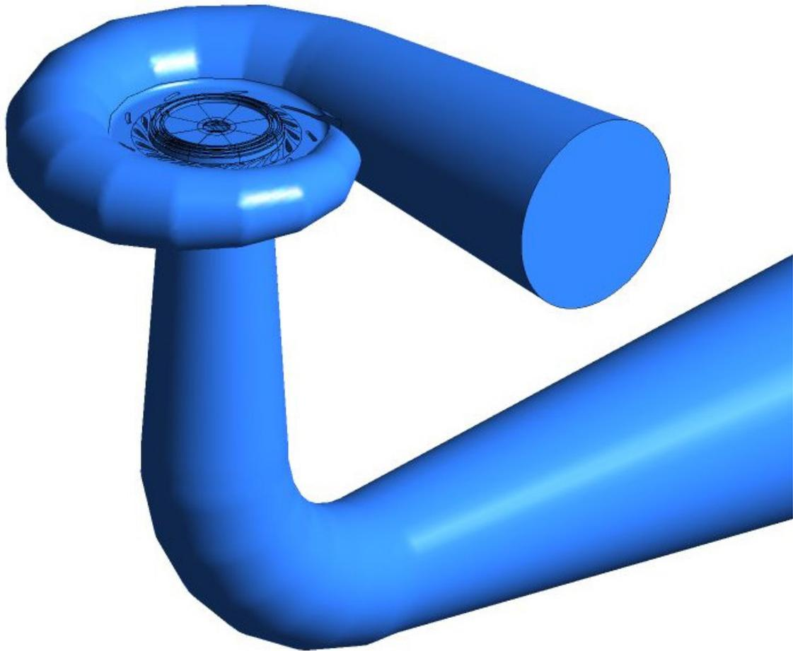
**Abb. 1-1 Strömungsraum der Referenzanlage mit Sicht auf den Laufradboden**
