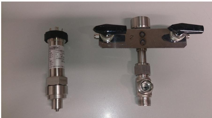
Abbildung 3.10: links: Drucksensor der Firma Omega rechts: Swagelok® Drei-Elektrodenzelle mit Spül-/Füllvorrichtung.
