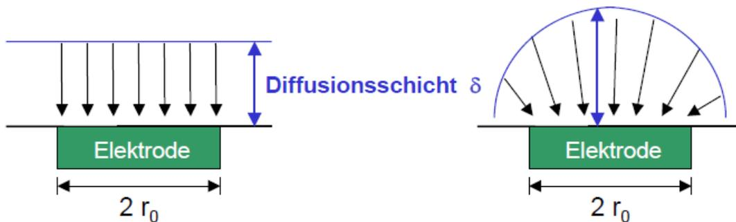
Abbildung 3.5: Schematische Darstellung der Ausprägungsformen der Diffusionsschicht in Abhängigkeit vom Elektrodenradius.<sup>47</sup>
