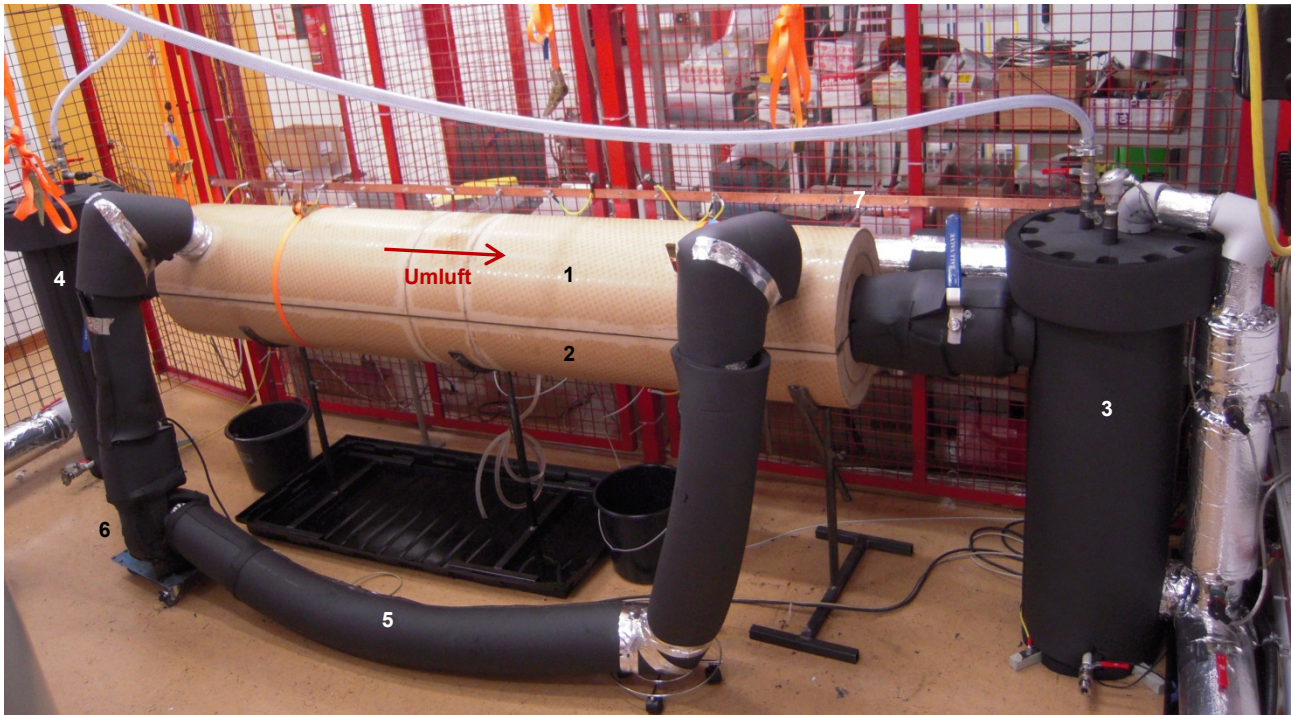
Abbildung 5-7: Versuchsstrecke der Strömungsmodellanlage mit Wärmedämmung
