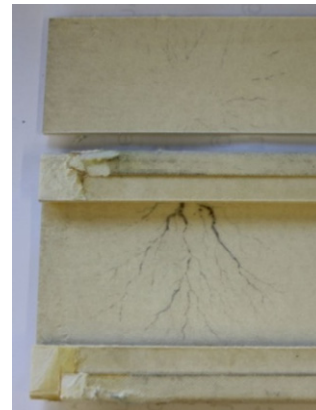
Abbildung 7-21: Entladespur auf Kanalinnenseiten des Nomex®-Modells
