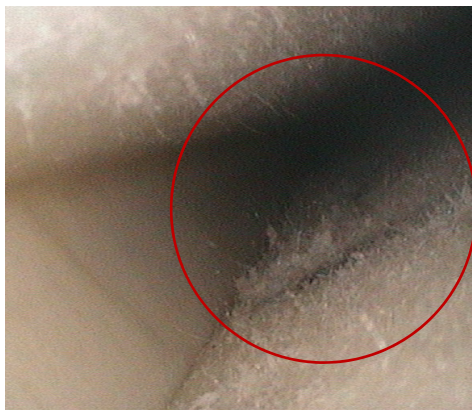
Abbildung 7-20: Verzweigte Entladespur an Kanalinnenseite des Nomex®-Modells, Endoskopaufnahme
