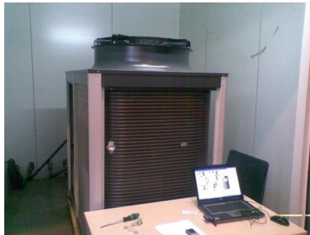
Abbildung 2-17: Bild des luftgekühlten Prototypen einer Ammoniak/Lithiumnitrat Absorptionswärmepumpe mit 10 kW Kälteleistung (Zamora et al., 2014)
