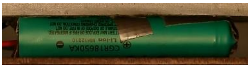
Abbildung 6. 4: Verformung einer 18650 Lithium-Ionen Zelle bei der Versuchsanordnung „Crush in X-Richtung“
