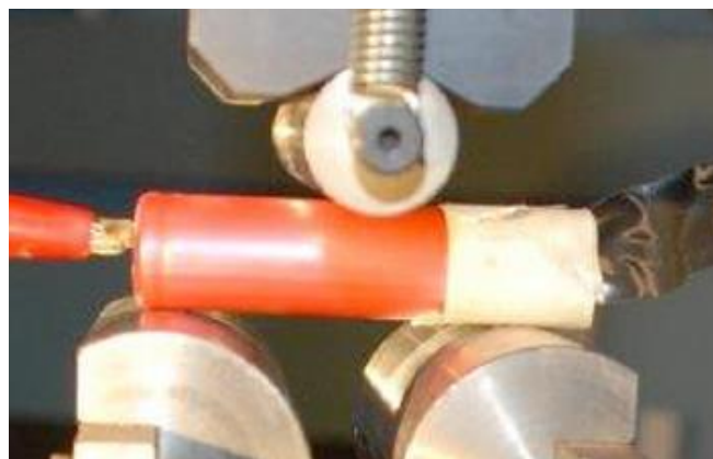
Abbildung 2. 7: 3-Punkt-Biegung nach Sahraei [32]
