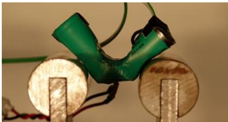
Abbildung 4. 2: Vollständige Deformation der Zelle bei der Versuchsanordnung „Crush 3 Punkt Biegung“ [11]
