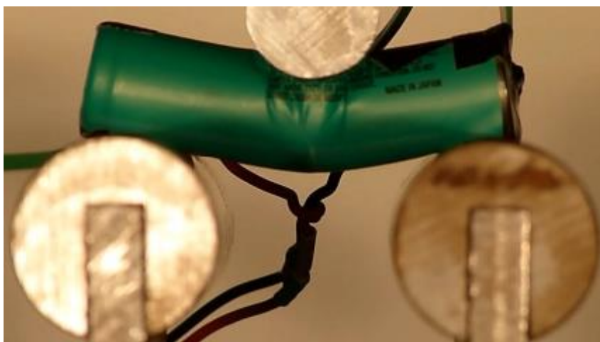
Abbildung 6. 18: Verformung einer 18650 Lithium-Ionen Zelle bei der Versuchsanordnung „Crush 3 Punkt Biegung“ [11]
