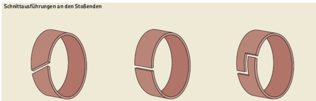
Abb. 79: Unterschiedliche Schnittausführungen für Führungselemente [1]
