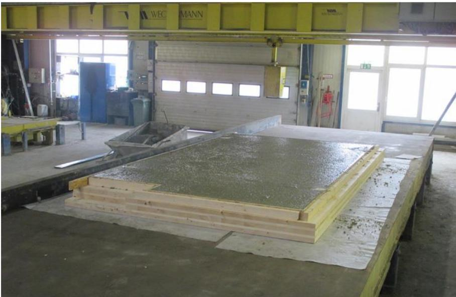
Bild 2.15 Herstellung von Holz-Beton-Verbunddecken in einem Fertigteilwerk
