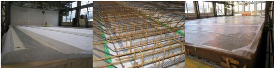
Bild 2.40 Herstellung einer Hohlkastendecke im Werk<sup>144</sup>
