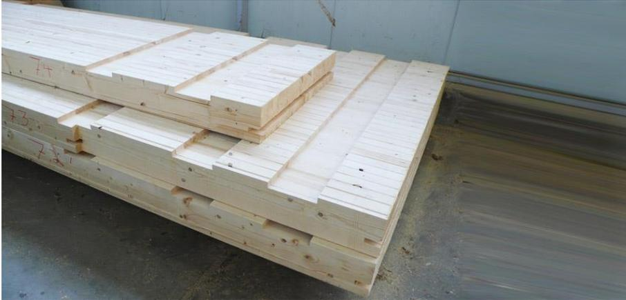
Bild 2.11 Kerven – Verbund einer Brettstapel Element einer HBV-Decke<sup>80</sup>
