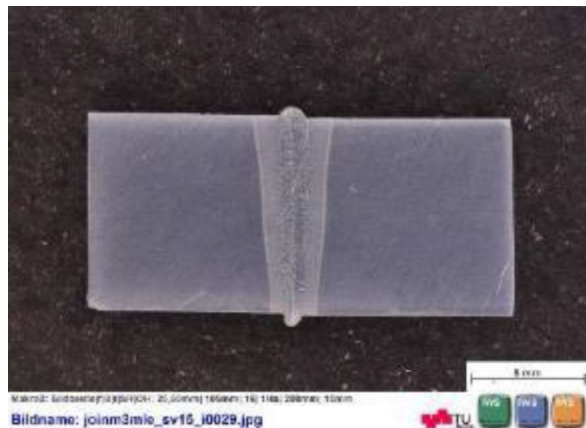
Abbildung 35: Verbindungsnahte Probe 22 mit Kantenanarbeitung und stirnseitigen Schweißpunkt, I=27,5 mA, v=19 mm/s, FL=-31 mm, Fq=600 Hz, Fig \varnothing=0,2 mm, HV=150 kV
