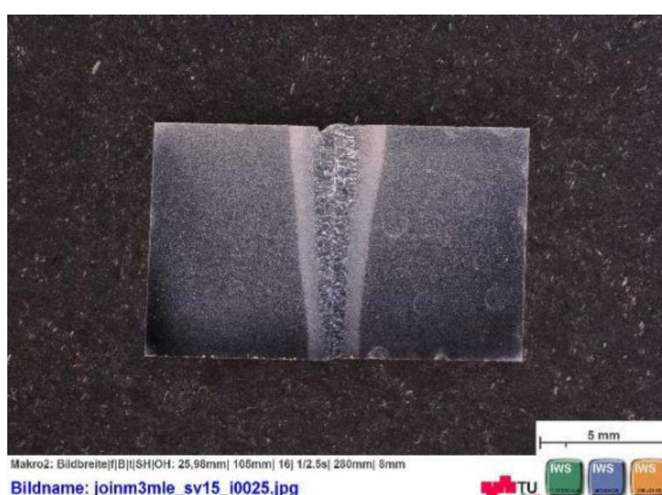
Abbildung 33: Verbindungsnahse Probe 13 mit unzureichender Nahtüberhöhung durch Kantenversatz
