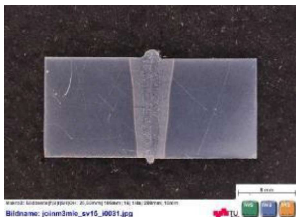
Abbildung 37: Verbindungsnahte Probe 25 mit Kantenanarbeitung und stirnseitigen Schweißpunkt, I=42 mA, v=28 mm/s, FL=-31 mm, Fq=600 Hz, Fig \varnothing=0,2 mm, HV=150 kV
