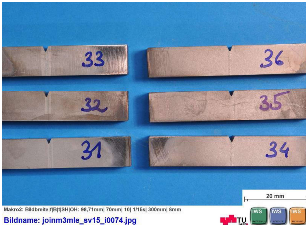
Abbildung 42: Fertig bearbeitete Kerbschlagproben K3 für Versuch bei -20\text{ °C} mit Probengröße 7 \times 10\text{ mm}^2 , I=42\text{ mA} , v=29\text{ mm/s} , Fq=600\text{ Hz} , Fig\ \varnothing=0,2\text{ mm} , HV=150\text{ kV}
