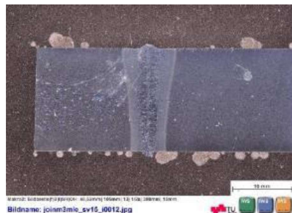
Abbildung 29: Blindnähte Probe 15, I=27,5 mA, v=17,5 mm/s, FL=-30,88mm
