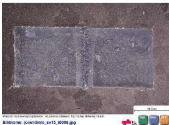
Abbildung 28: Blindnähte Probe 08, I=35 mA, v=20 mm/s, FL=-12mm
