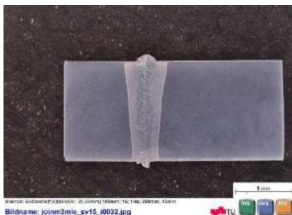
Abbildung 38: Verbindungsnähte Probe 26 mit Kantenanarbeitung und stirnseitigen Schweißpunkt, I=44 mA, v=30 mm/s, FL=-31 mm, Fq=600 Hz, Fig \varnothing=0,2 mm, HV=150 kV
