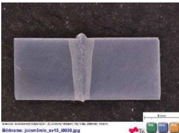
Abbildung 36: Verbindungsnahte Probe 23 mit Kantenanarbeitung und stirnseitigen Schweißpunkt, I=37 mA, v=28 mm/s, FL=-31 mm, Fq=600 Hz, Fig \varnothing=0,2 mm, HV=150 kV
