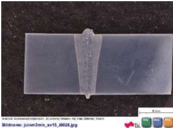
Abbildung 34: Verbindungsnahte Probe 18 mit Kantenanarbeitung und stirnseitigen Schweißpunkt, I=40 mA, v=27 mm/s, FL=-31 mm, Fq=600 Hz, Fig \varnothing=0,2 mm, HV=150 kV
