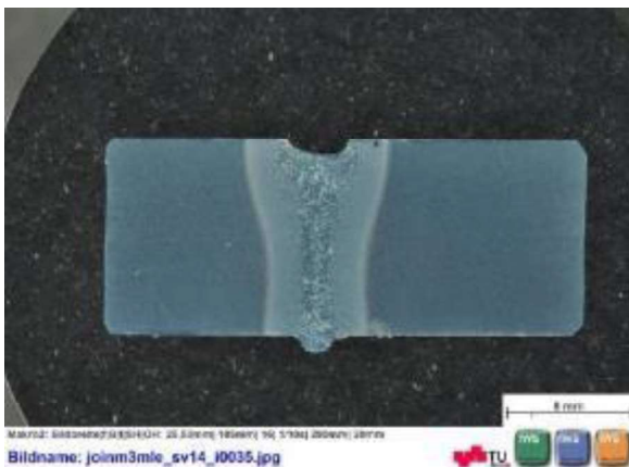
Abbildung 26: Blindschweißung geätzt aus Probe 3.2, I=25 \text{ mA} , v=5 \text{ mm/s}
