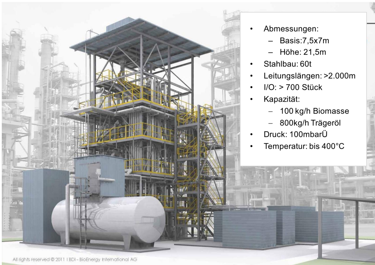
Abbildung 4.3: 3D-Modell und Eckdaten der bioCRACK Pilotanlage
