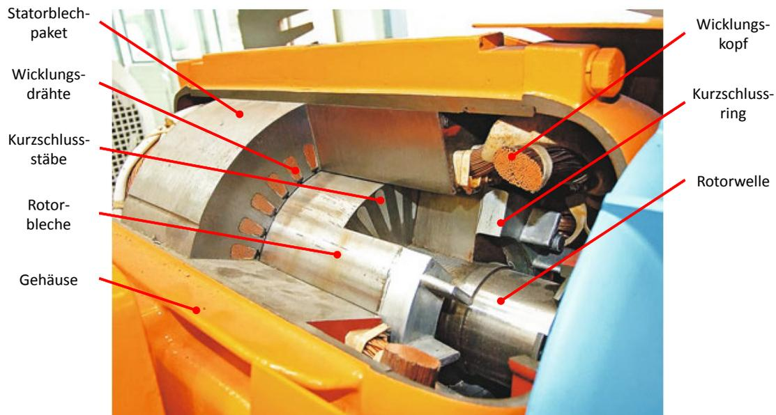
Abbildung 1.1.: Schnitt durch eine Asynchronmaschine. Bild entnommen aus [4][S. 269] mit freundlicher Genehmigung des Autors, Anmerkungen hinzugefügt.
