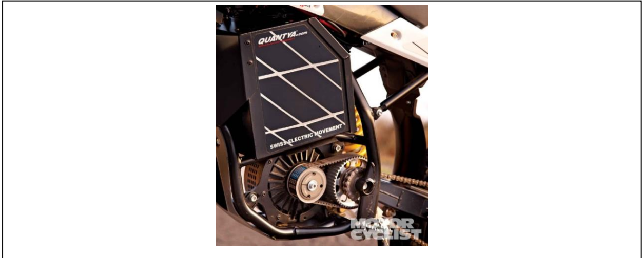
Abbildung 3-21: Detailansicht Quantya EVO1 Antriebseinheit und Energiespeicher 108
