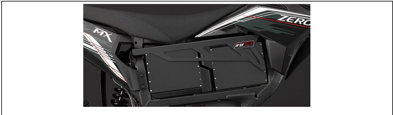
Abbildung 3-23: Modulares Energiespeichersystem von Zero 111
