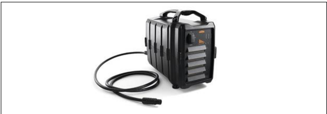
Abbildung 3-6: Ladegerät der Freeride-E Modelle von KTM 83
