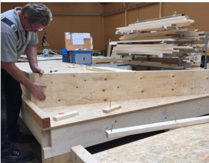
Abbildung 3.69: Zusammenbau des Riegelwerkes (Projekt B)
