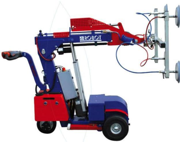
Abbildung 5.10: Montagegerät für den Fenstereinbau für AS4 (Projekt A)<sup>449</sup>
