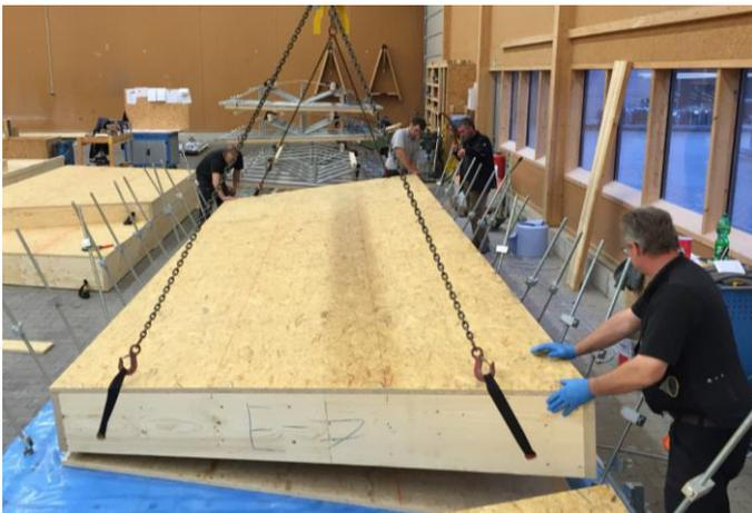
Abbildung 3.76: Pressvorbereitung Riegelwerk (Projekt B)
