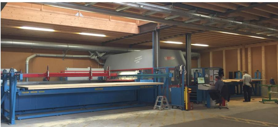
Abbildung 3.6: Plattenbearbeitungsmaschine SPM2 (Zimmerei Sieveke GmbH)
