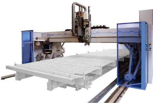
Abbildung 2.41: Multifunktionsbrücke vom Typ Weinmann WMS 120<sup>269</sup>
