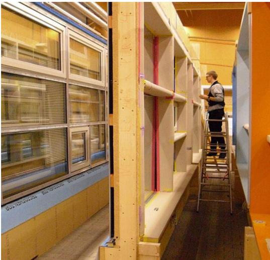
Abbildung 3.2: Holztafelbaufertigung in der Zimmerei Sieveke GmbH<sup>386</sup>
