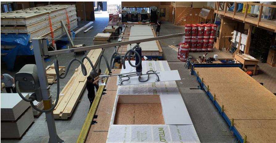
Abbildung 3.7: Vorfertigung von Holzrahmenelementen (Zimmerei Sieveke GmbH)
