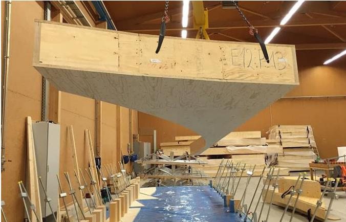
Abbildung 3.79: Entleeren des Presstisches (Projekt B)
