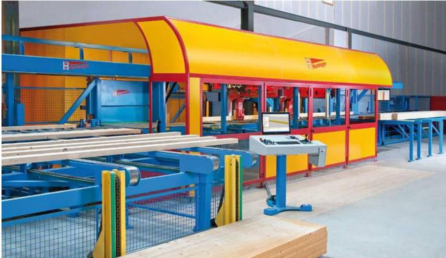
Abbildung 2.39: Automatische Abbundanlage vom Typ Hundegger K2i<sup>262</sup>
