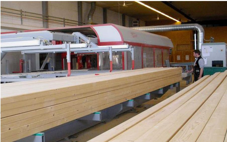
Abbildung 3.5: Abbundmaschine K2i (Zimmerei Sieveke GmbH)<sup>391</sup>
