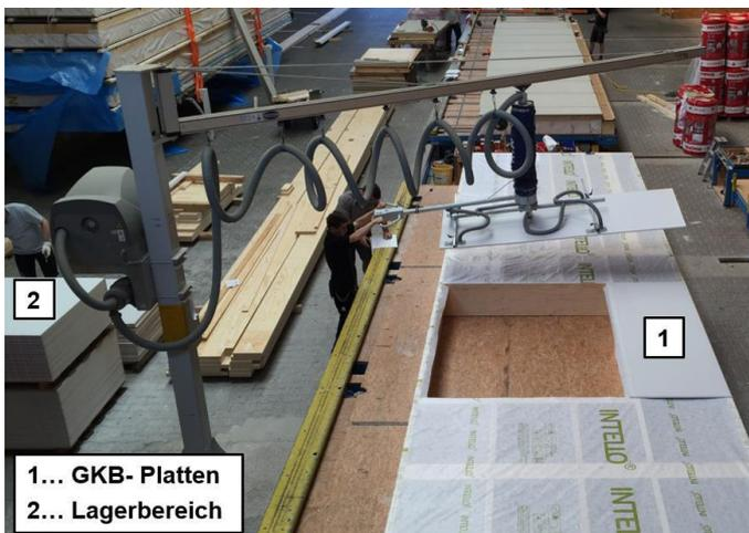
Abbildung 3.38: Montage der inneren Beplankung (Projekt A)
