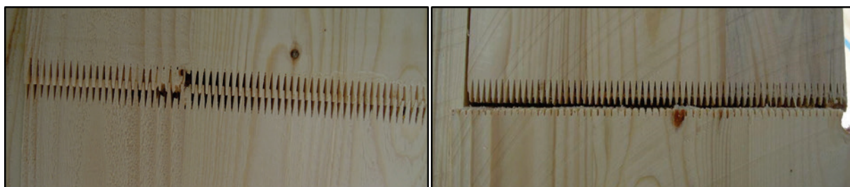
Abbildung 6-5: Bruchbilder Keilzinken im Biegezugbereich (links: Ausziehen der Keilzinken, rechts: nicht vollständig gefrägte Keilzinke)
