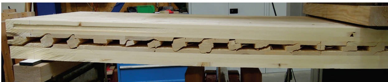
Abbildung 6-6: Rollschubversagen der Querlage
