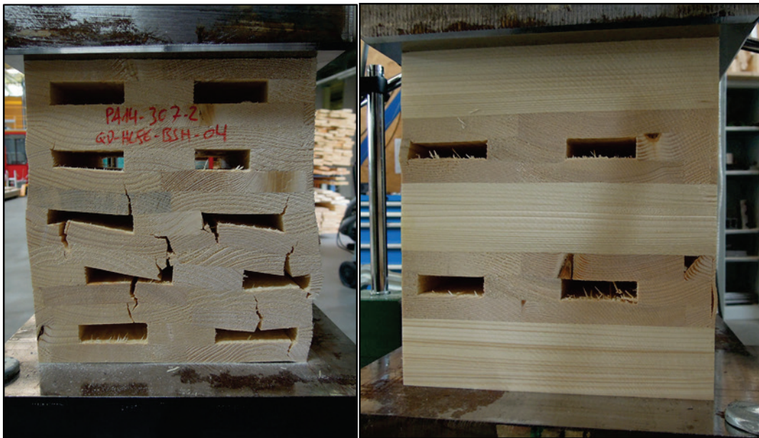
Abbildung 6-8: Bruchbilder Querdruckprüfungen (links: QD-HL86-BSH, rechts: QD-HL86-BSP)
