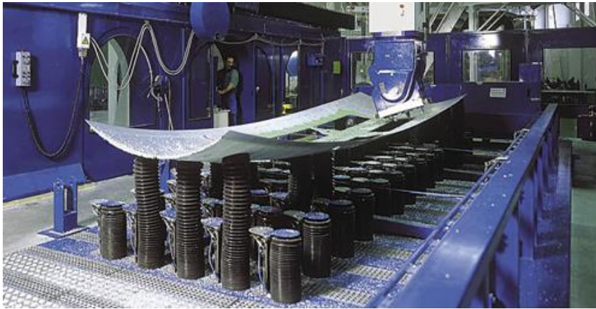
Abbildung 5: Universelle Spannvorrichtung mit fixen Raster, Quelle: Lorincz (2012), S. 96.
