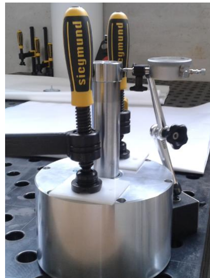
Abbildung 29: Messaufbau Führungsspielauswirkungen auf Vakuumkopf, Quelle: Eigene Darstellung.
