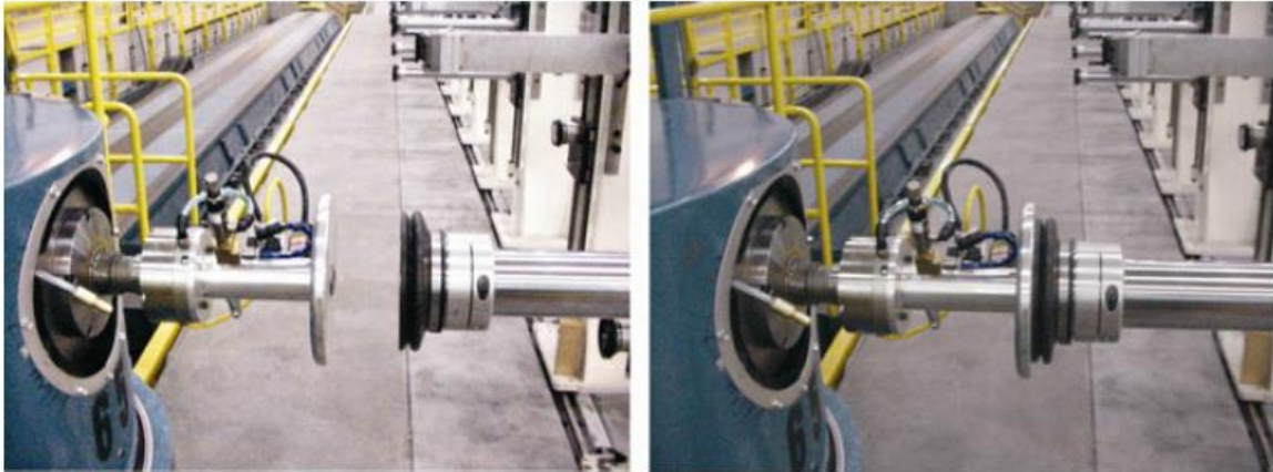
Abbildung 6: Ankopplung der Werkzeugmaschinen an das passive UHF-Element, Quelle: Schwock (2010), S. 272.
