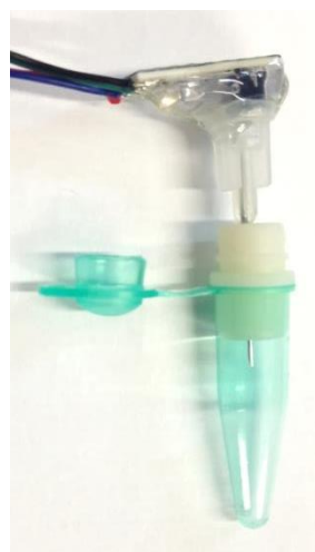
Abbildung 2-15: Einstichsensor, angewandt in einem 200µl Vial welches durch eine Dichtung des Schlauchsets SCS001 (Joanneum Research, Österreich) verschlossen ist.
