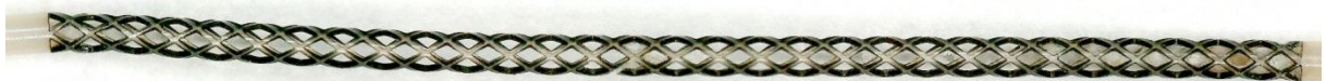
Abbildung 2-4: 0,5mm PEEK dOFM-Katheter mit großen Löchern unter dem Mikroskop, 50-fach vergrößert, am Versuchsende aus der Haut des Versuchstieres explantiert
