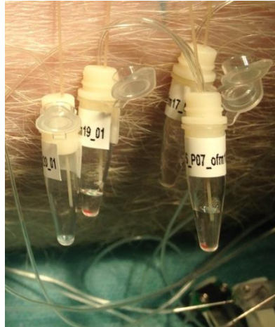
Abbildung 2-10: Vials mit Umgebungsdruck, der Katheter steckt in der Dichtung
