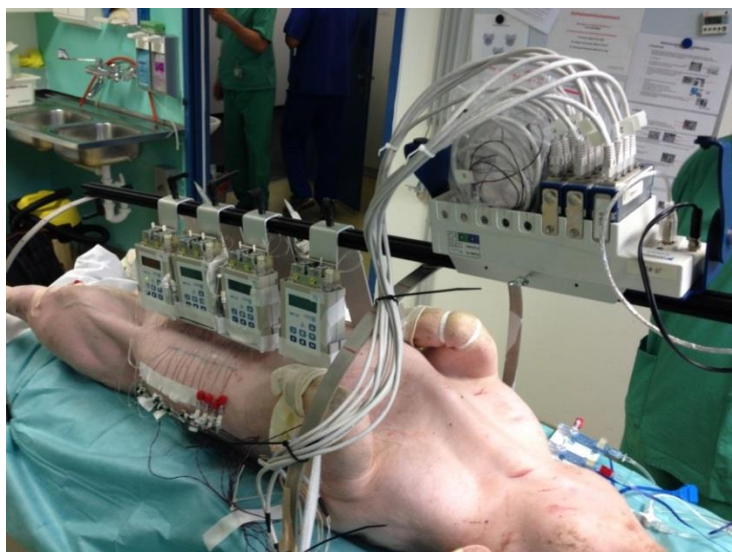
Abbildung 2-30: Fertig aufgebautes Versuchsetup. Die Pumpen sowie die Messhardware sind oberhalb des Versuchstieres angebracht.
