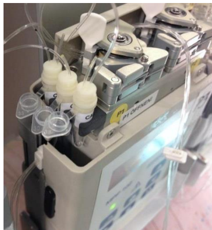
Abbildung 2-9: Vialhalterung seitlich der Pumpköpfe mit eingelegten Vials während eines Versuches
