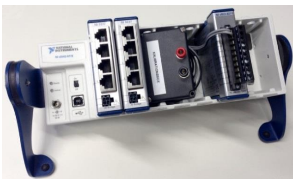
Abbildung 2-17: NI cDAQ 9172 Gehäuse mit eingesetzten Messmodulen sowie Adapter des Referenzsensors
