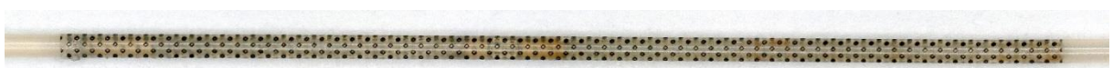
Abbildung 2-6: 0,5mm PEEK dOFM-Katheter mit Mikrolöchern unter dem Mikroskop, 50-fach vergrößert, am Versuchsende aus der Haut des Versuchstieres explantiert
