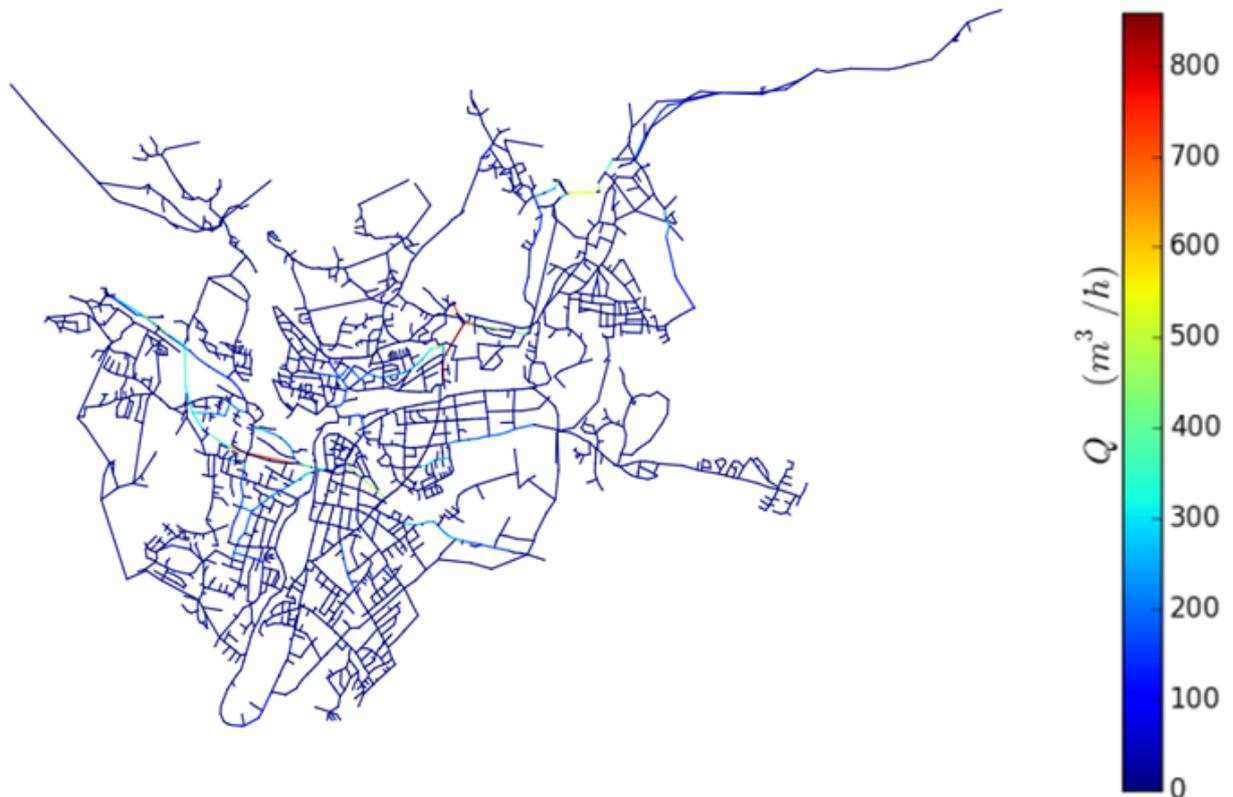
Abbildung 15: ILC-Ausflussmenge bei Längsriss  $l=40\text{cm}$
