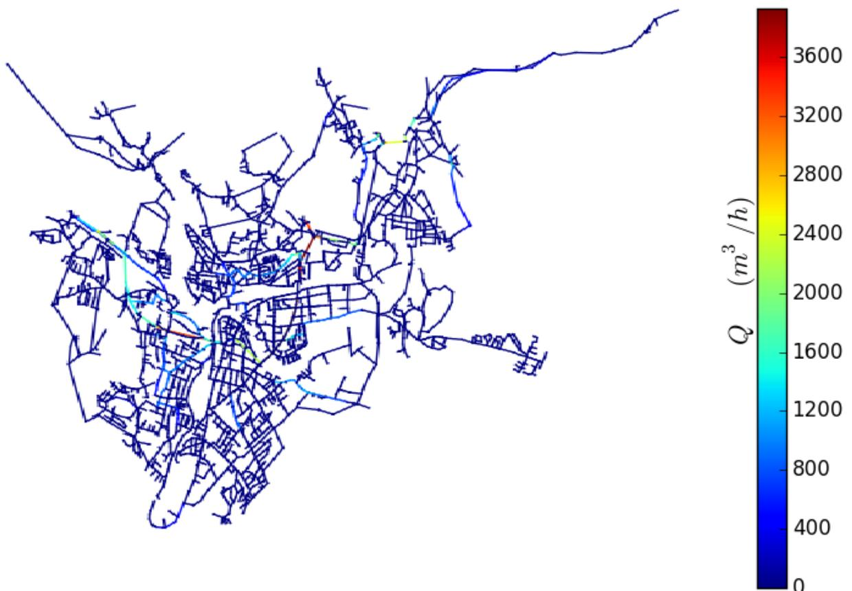
**Abbildung 17: ILC-Ausflussmenge bei Längsriss l=200cm**
