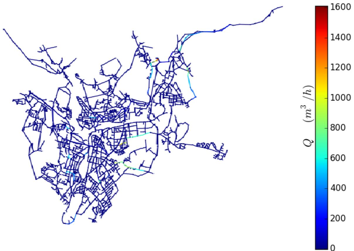
Abbildung 16: SLC-Ausflussmenge bei Längsriss  $l=200\text{cm}$
