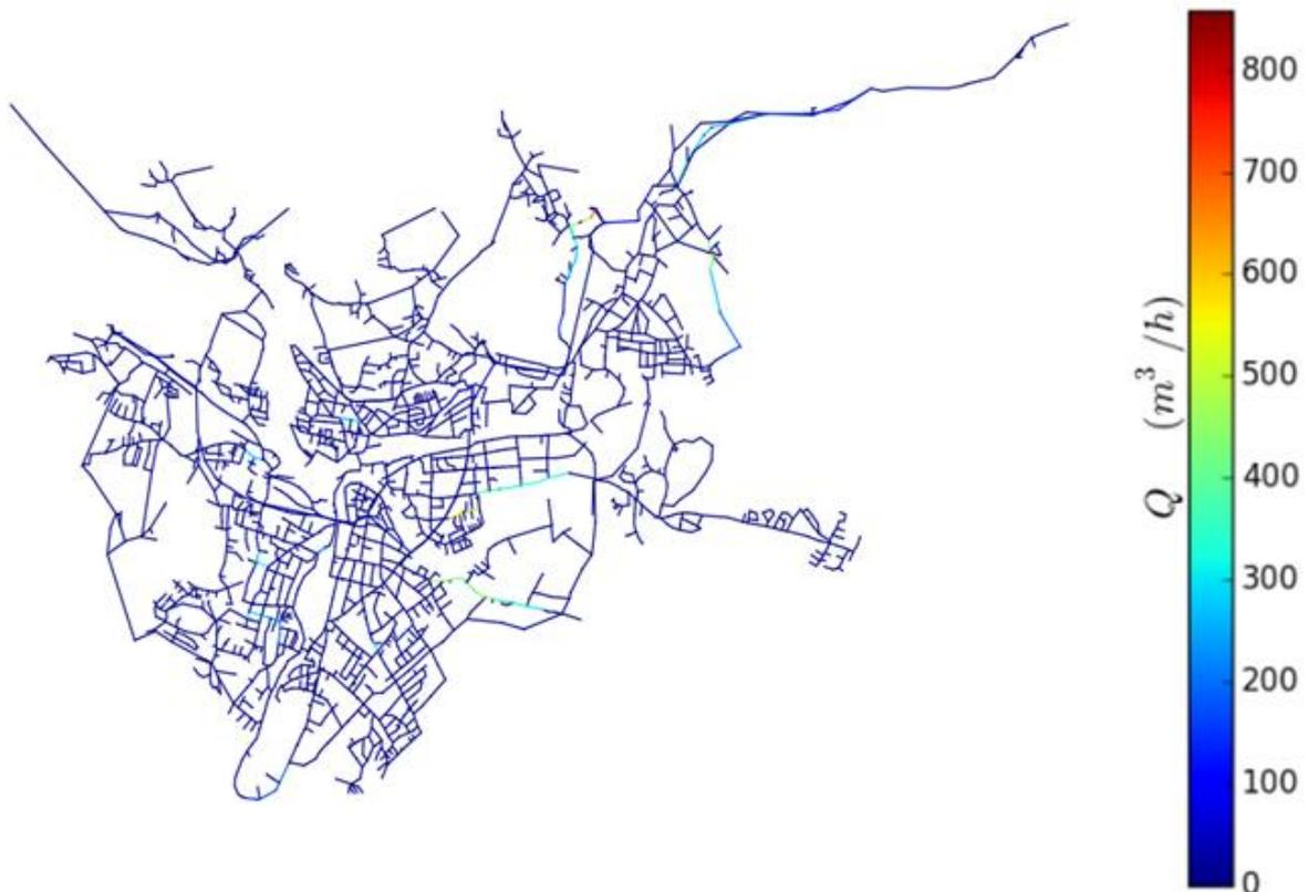
Abbildung 14: SLC-Ausflussmenge bei Längsriss  $l=40\text{cm}$
