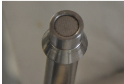
Abbildung 20: Verschlussplättchen in Reaktorende verbaut
