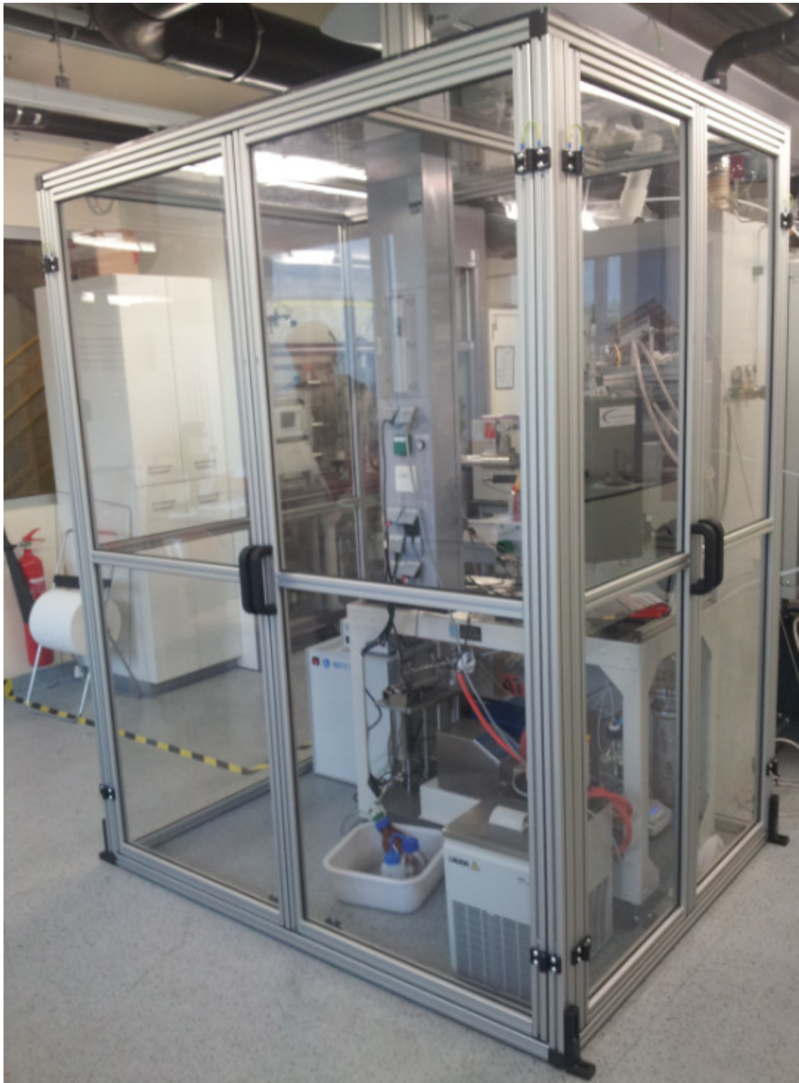
Abbildung 46: Einhausung der Anlage
