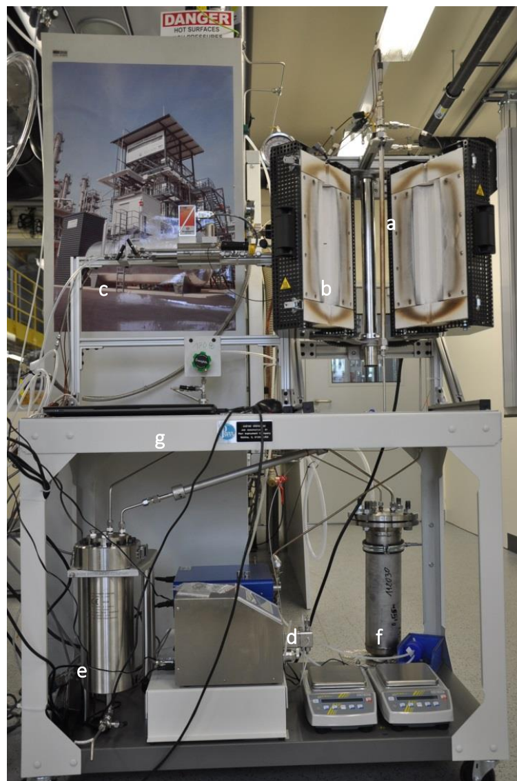
Abbildung 14: Versuchsaufbau: a) Rohrreaktor; b) Heizmantel und Temperatursensor; c) Gaszuleitung; d) Pumpen und Waagen; e) Produktbehälter; f) Expansionsbehälter; g) Laptop.
