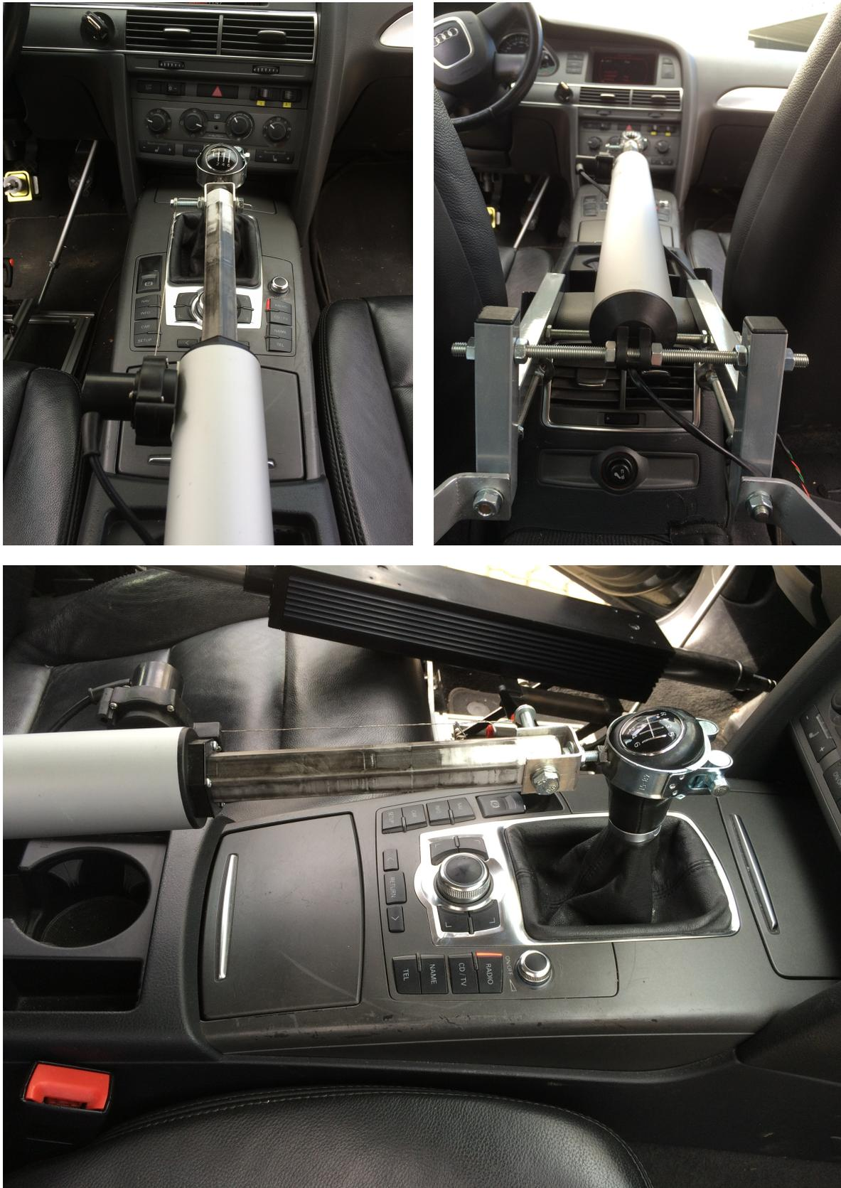
Abbildung 8.2: Schaltaktuator im Versuchsfahrzeug
