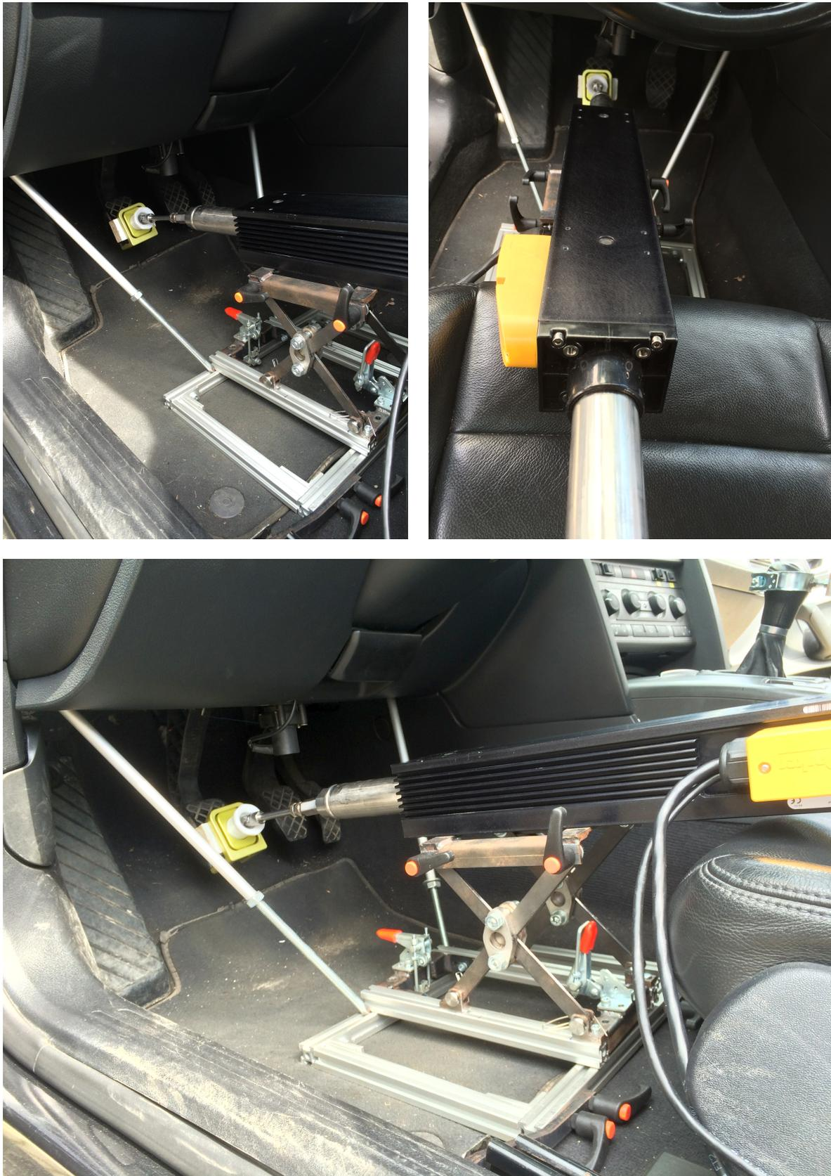
Abbildung 8.1: Kupplungsaktuator im Versuchsfahrzeug
