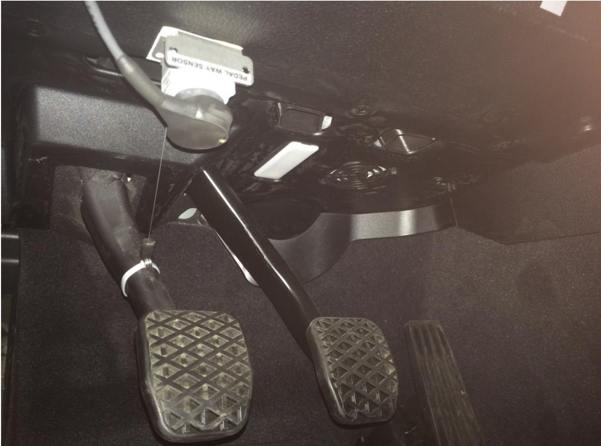
Abbildung 4.1: Seilzugpotentiometer für die Wegmessung am Kupplungspedal
