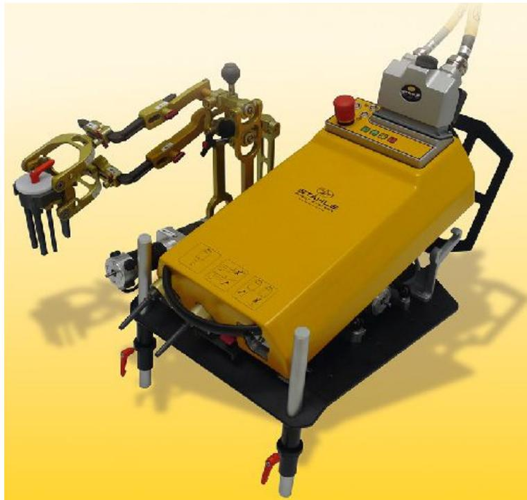
Abbildung 3.9: Stähle SAP2000 Fahrroboter [13]
